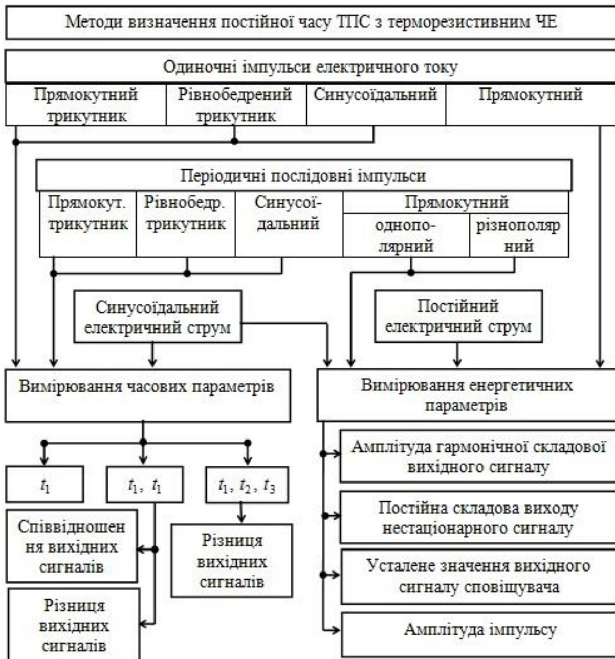
Рис. 1.23 Структурна схема класифікації методів визначення постійної часу ТПС з терморезистивним чутливим елементом внутрішнім тепловим впливом
