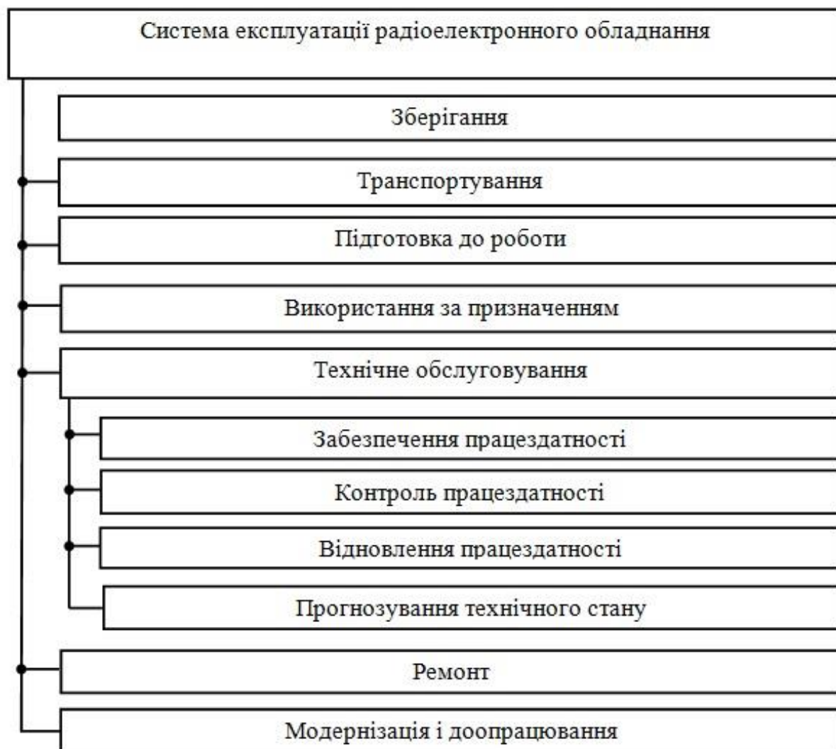
Рис. 1.24. Структурна схема експлуатації радіоелектронного обладнання
