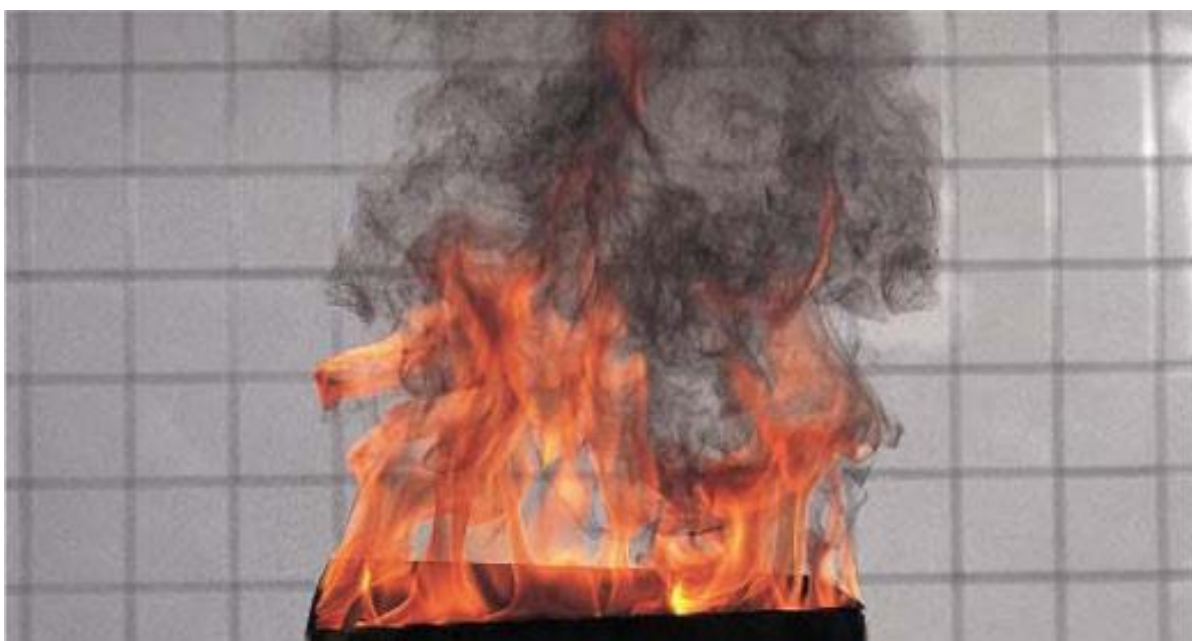
Рис. 1.13. Тестовий осередок пожежі TF-5
