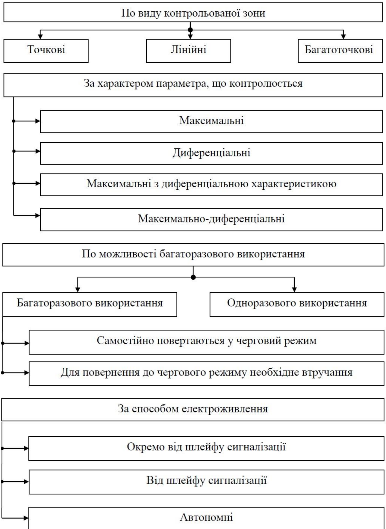
Рис. 1.1. Структурна схема класифікації ТПС
