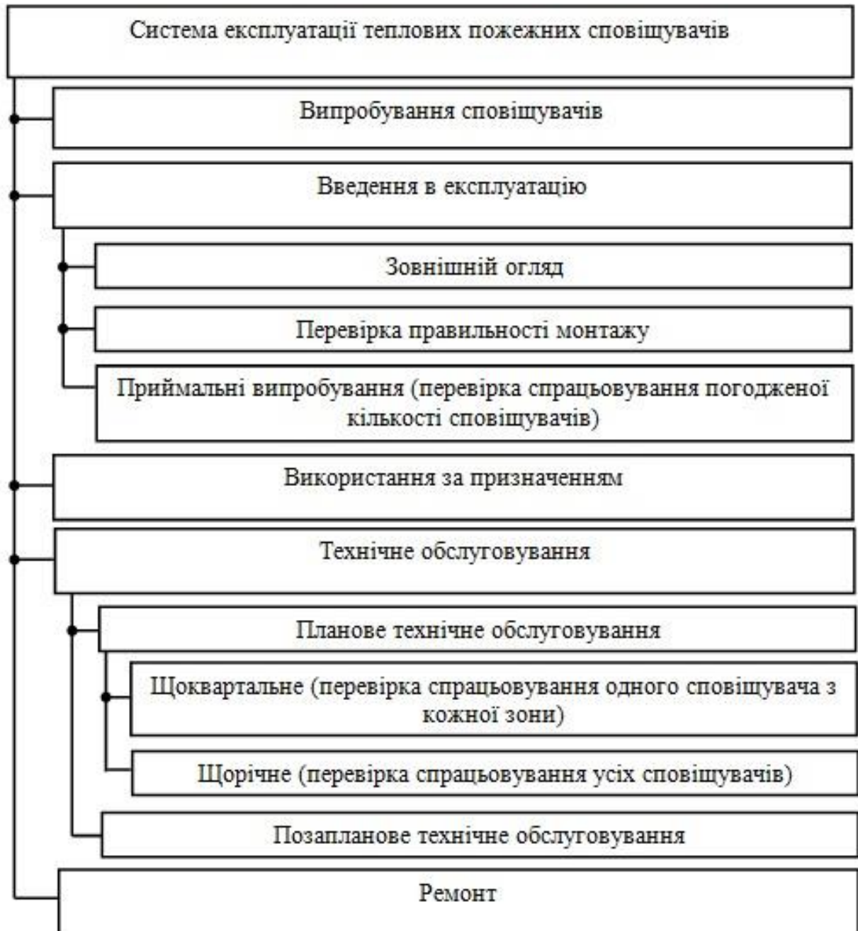
Рис. 1.4. Структурна схема експлуатації ТПС
