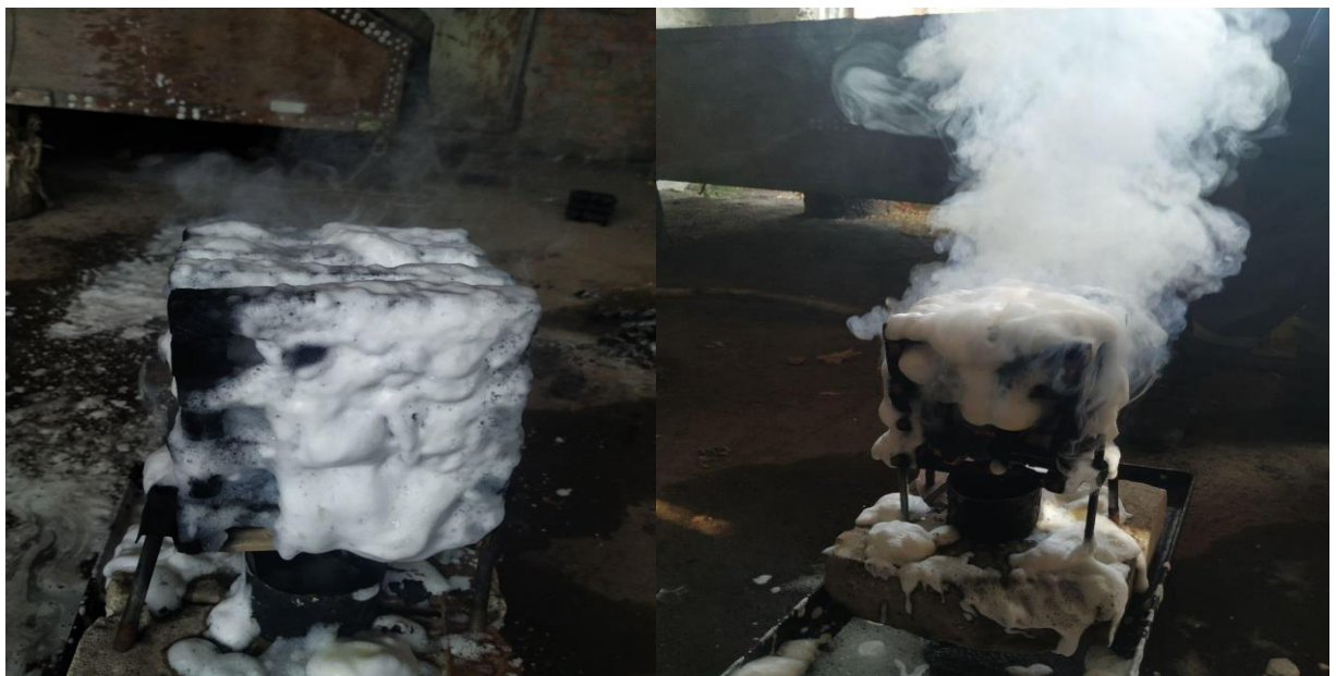
Рис 3.14. Лабораторне модельне вогнище пожежі, погашене компресійною піною кратністю 20
