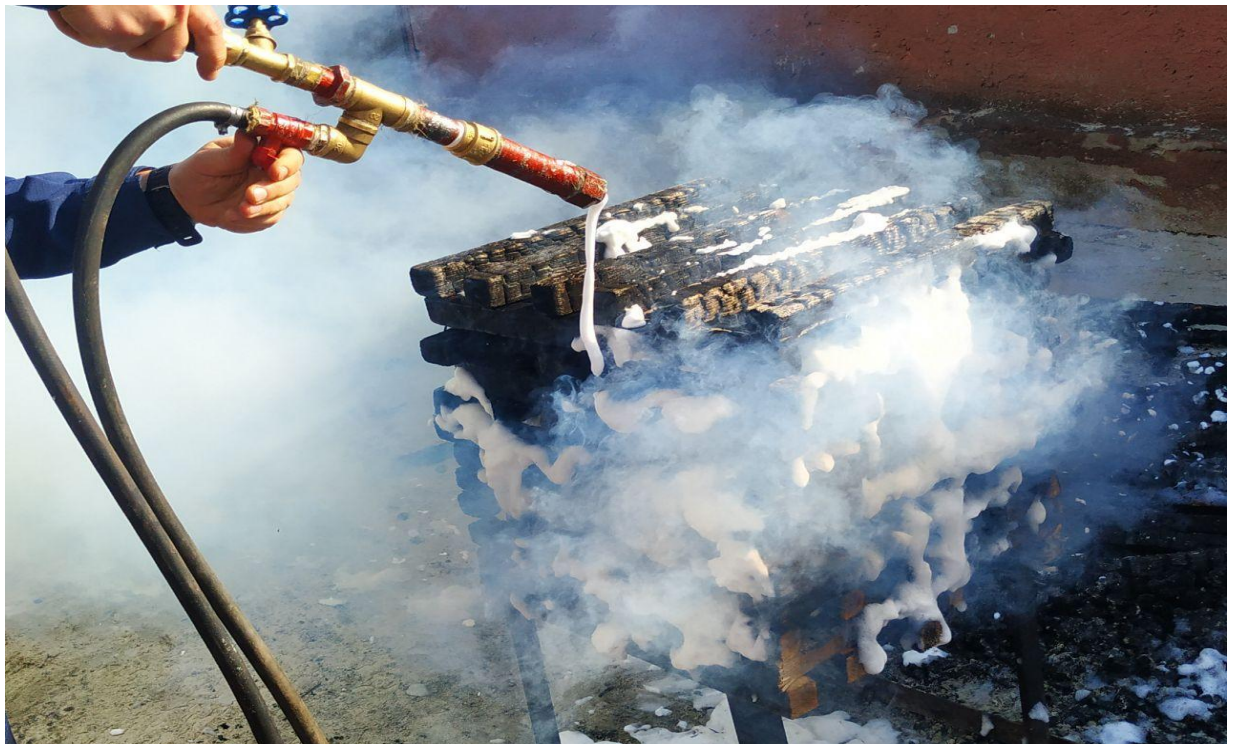
Рис. 3.31. Фото процесу гасіння модельного вогнища пожежі компресійною піною
