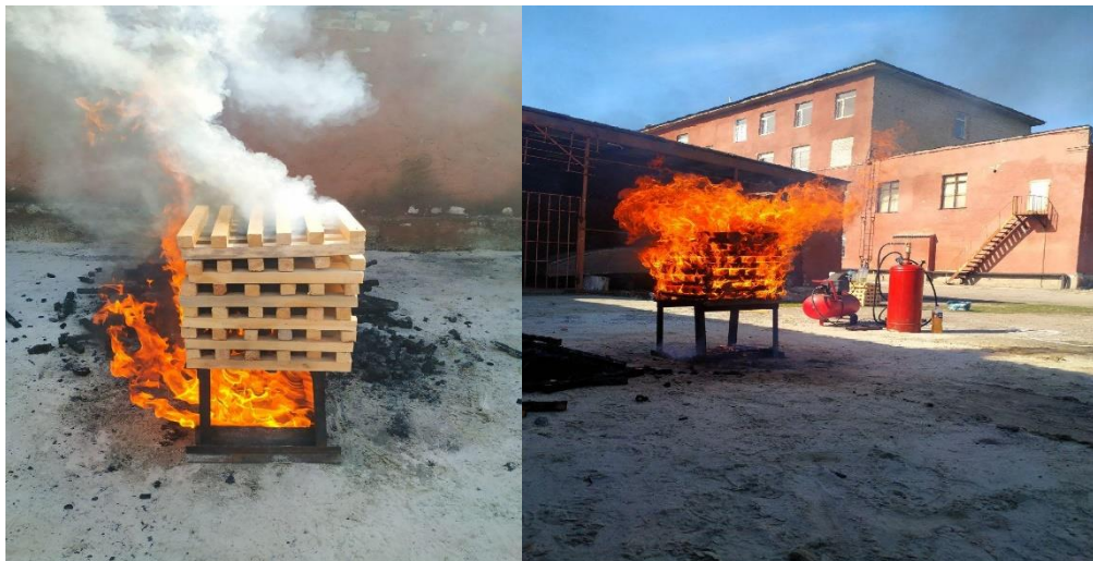
а) б) Рис. 3.29. Фото модельного вогнища вогнища пожежі: а) стан модельного вогнища на початку горіння; б) стан модельного вогнища після 7 хвилин вільного горіння
