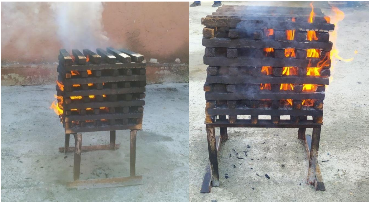
Рис. 3.32. Фото модельного вогнища після гасіння водою (через 5 хвилин спостерігалось повторне займання)
