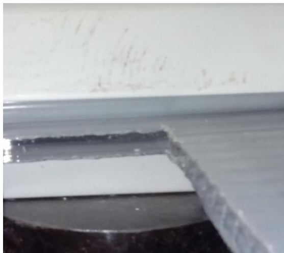
Рис. 2.6. Зовнішній вигляд та внутрішня структура полікарбонатного стільникового листа
