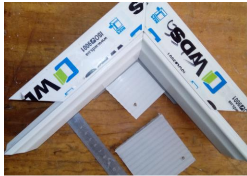
Рис. 3.7. Зовнішній вигляд для випробувань щодо експериментального визначення розподілених сил тертя, що утримують стільникові полікарбонатні листи у вузлах кріплення
