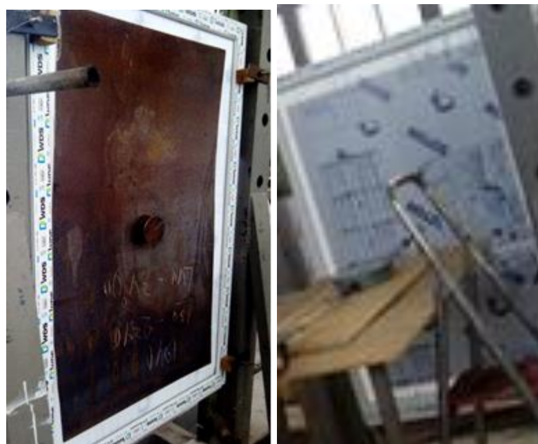
Рис. 3.2. Загальний вигляд рами зі змонтованим стільниковим полікарбонатним листом перед випробуванням
