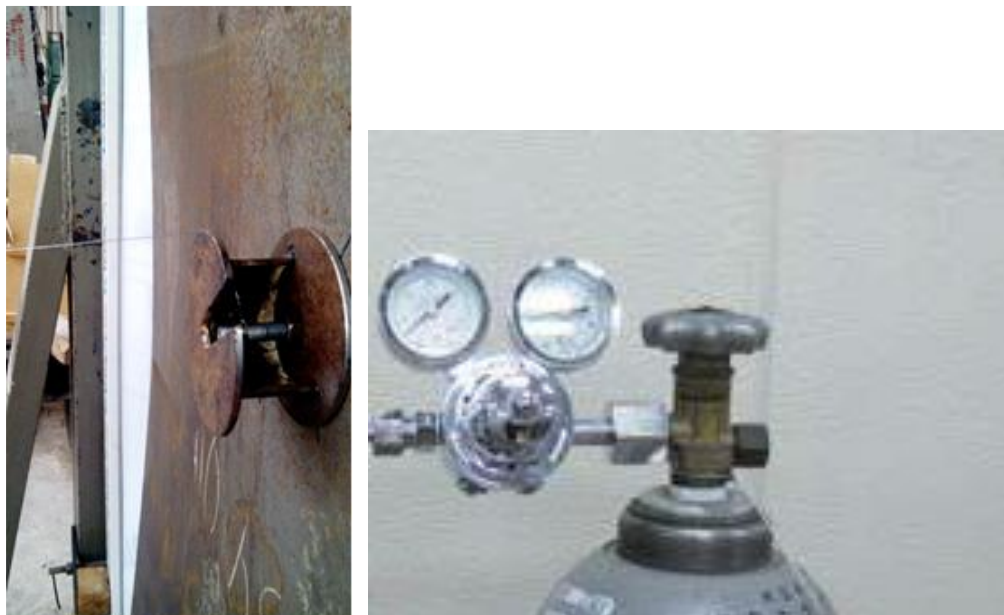
Рис. 3.4. Схема розташування кронштейну для прикладення навантаження та встановлення динамометра ДПУ-0,5-2 і балона стиснутого повітря з редуктором
