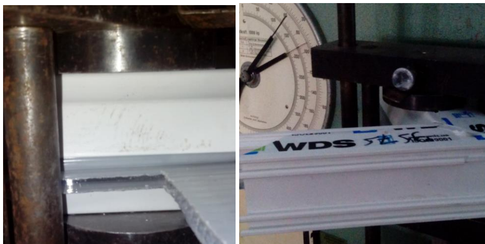
Рис. 3.9. Загальний вигляд установки для випробування на визначення здатності утримання полікарбонатного листа силами тертя
