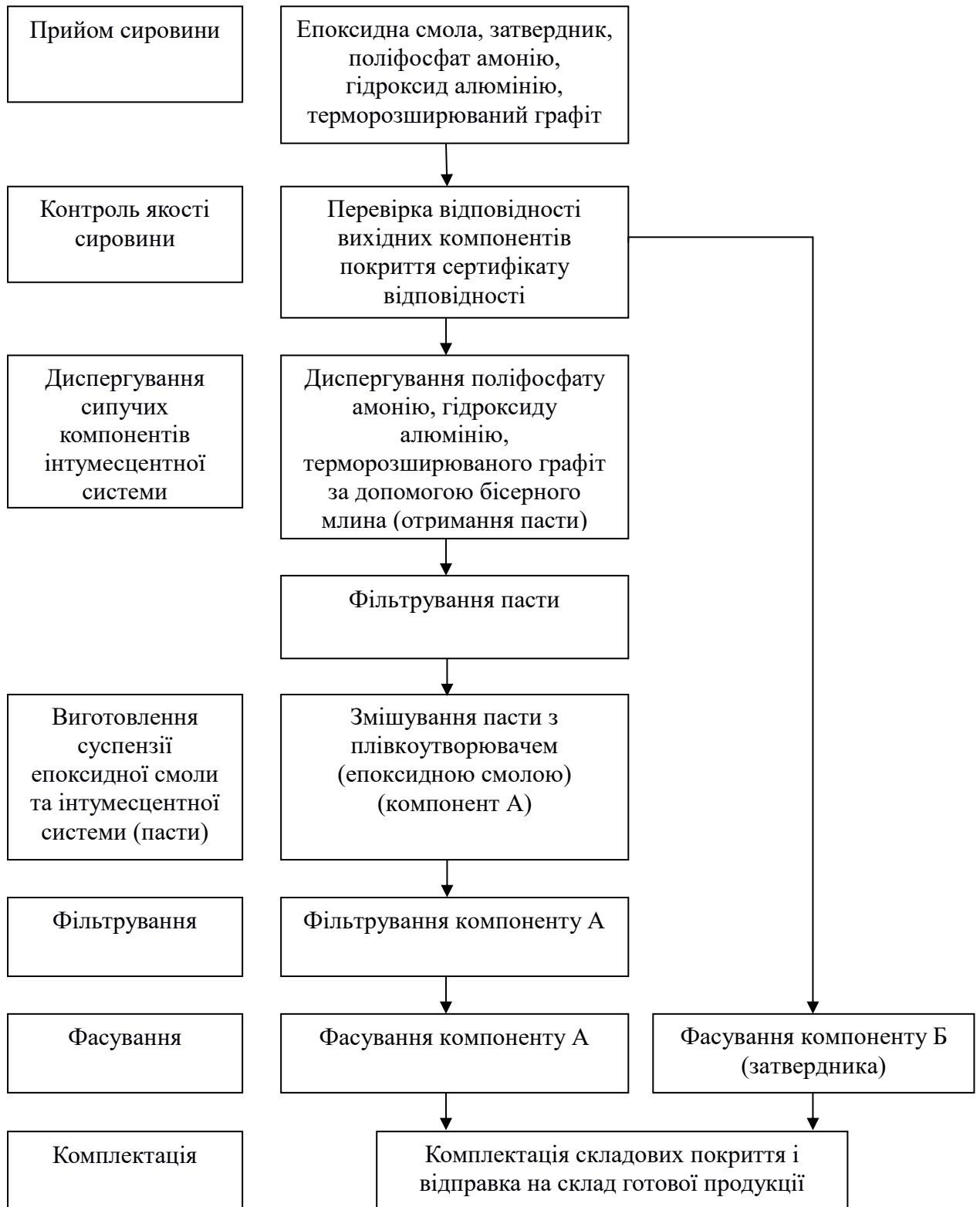
Рис. 4.2. Принципова технологічна схема виробництва інтумесцентного вогнезахисного покриття ПАГ-2
