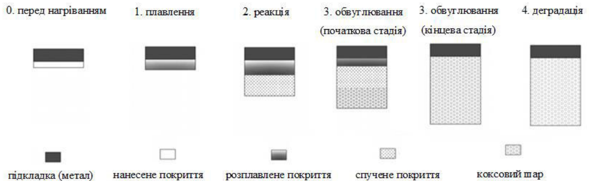
Рис. 1.6. Етапи спучення інтумесцентного вогнезахисного покриття
