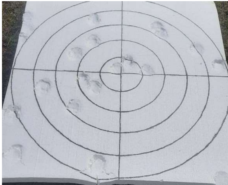
Рис. 3.9. Експериментальне дослідження купності дискретної подачі вогнегасних речовин, 9 метрів до мішені (пробне випробування)
