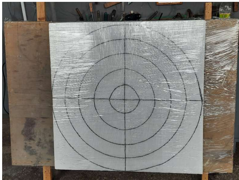
Рис. 3.8. Мішень з пінопласту для експериментальних досліджень прикріплена до деревного щита за допомогою стрічки поліетиленової
