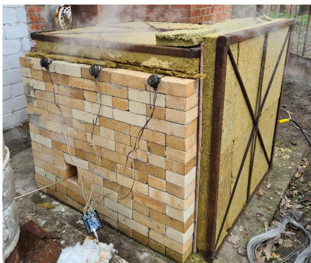
Рис. 2.1. Конструкція та схема випробувальної установки на основі вогневої печі: 1 – верхня огорожувальна система вогневої печі установки; 2 – ущільнювач з мінераловатної плити та вогнетривкового шнура; 3 – газові пальники, що забезпечують відповідний температурний режим пожежі у камері печі; 4 – огорожувальні стінки печі; 5 – нагрівальні канали для пальників, які не використовуються; 6 – отвір для виходу пічних газів.
