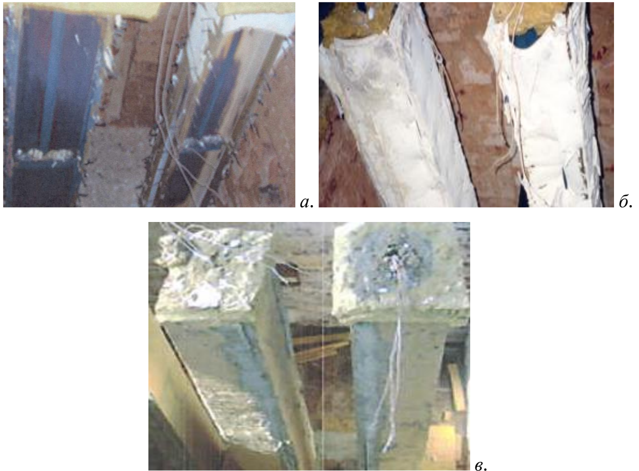
Рис. 3.1. Вигляд зразків фрагментів сталевих балок після випробувань: а – зразки № 1 та № 2 (товщина облицювання 12.5 мм); б – зразки № 3 та № 4 (товщина облицювання 25 мм); в – зразки № 5 та № 6 (товщина облицювання 37.5 мм).
