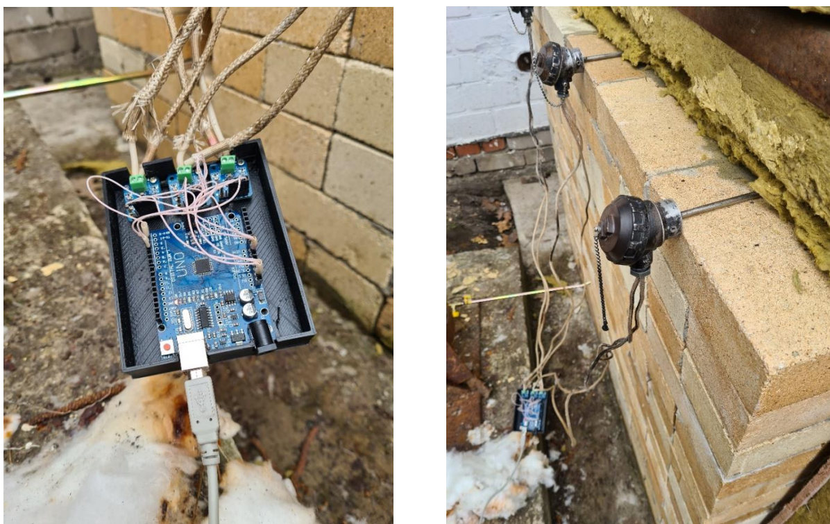
Рис. 2.3. Схема підключення термопар до вимірювального комплексу.
