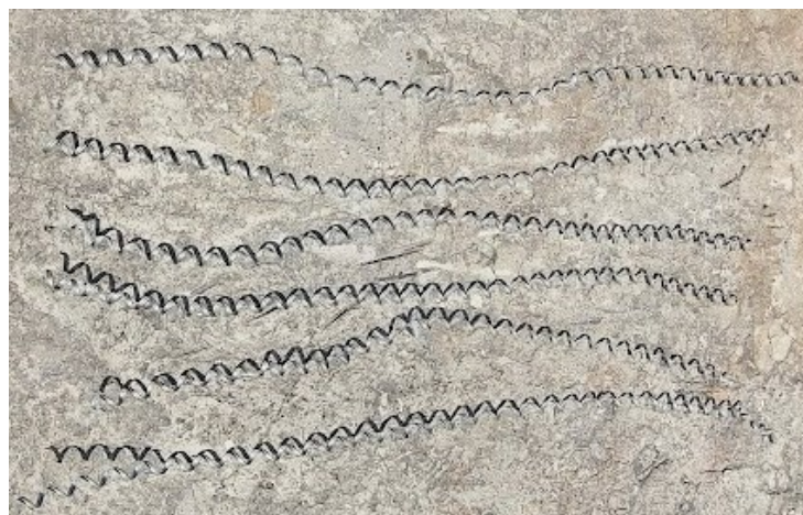
Рисунок 3.6 – Металеві стрічки – спіралі для улаштування всередині гофротрубок
