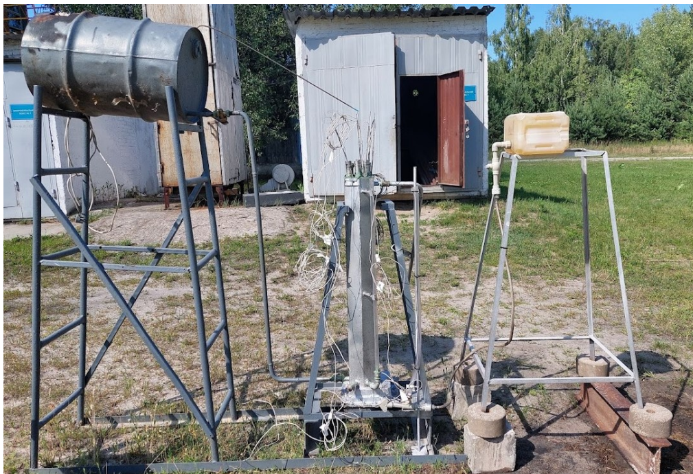
а) Експериментальна установка без опорядження теплоізоляційною мінеральною ватою
