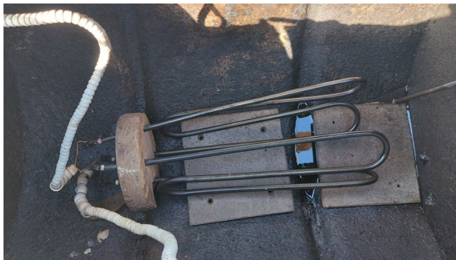
Рисунок 3.3 – Розміщення ТЕНів для нагрівання масла в резервуарі (1)
