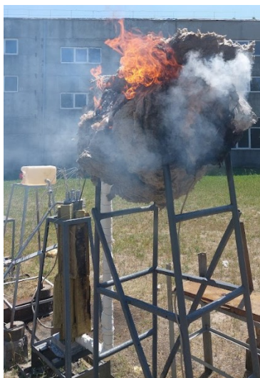
Рисунок 3.10 – аварійна ситуація, що виникла при пробному нагріві трансформаторного масла
