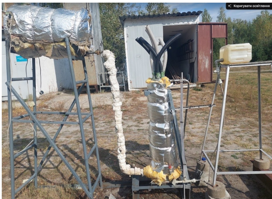
б) Експериментальна установка з опорядженням теплоізоляційною мінеральною ватою
