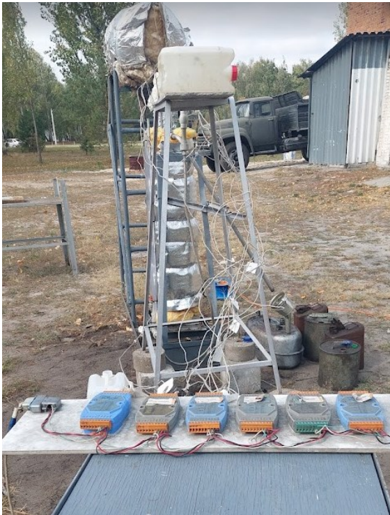
Рисунок 3.9 – система аналогово-цифрових перетворювачів інформаційно-вимірювальної системи «Термоконт» та комп'ютер з програмним забезпеченням для вимірювання та реєстрації температури.
