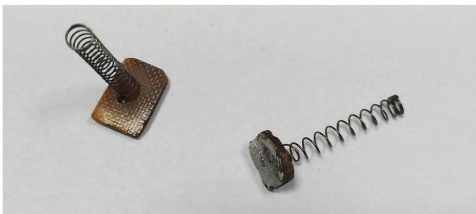
Рис. 5.12 Модифіковані підпружинені контактні пари
