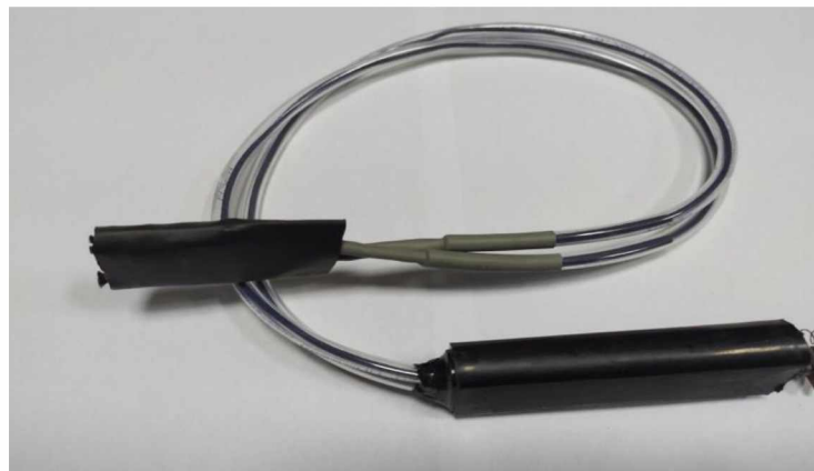
Рис. 5.10 Датчик для вимірювання електричного опору шару кіптяви на горизонтальних поверхнях на основі підпружинених контактів
