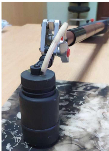
Рис.5.4. Поворотний механізм з фіксаторами кута нахилу блоку детектування
