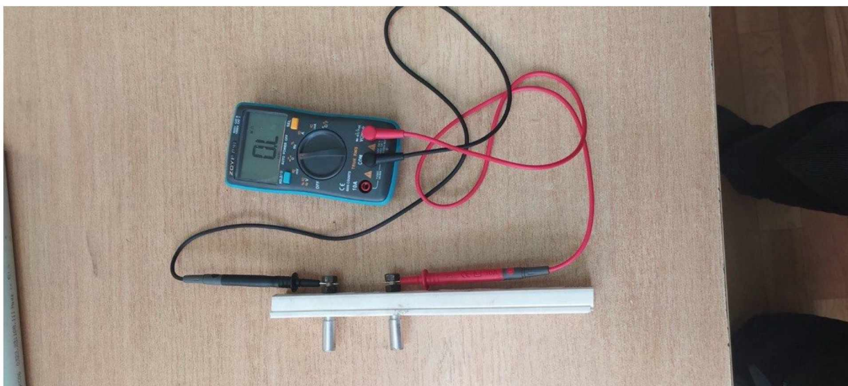
Рис.5.2. Прилад для вимірювання електричного опору шару кіптяви на горизонтальних поверхнях на основі жорстких контактів
