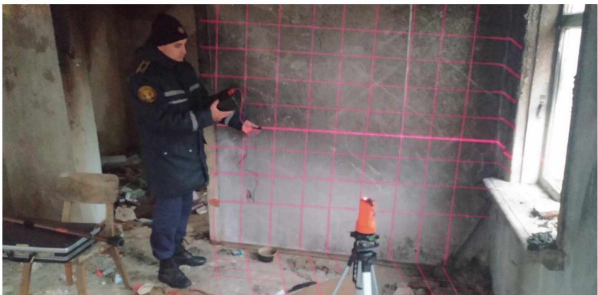
Рис. 4.2 Дослідження кіптяви датчиком для горизонтальних поверхонь з нанесеною на стіну лазерною розміткою.
