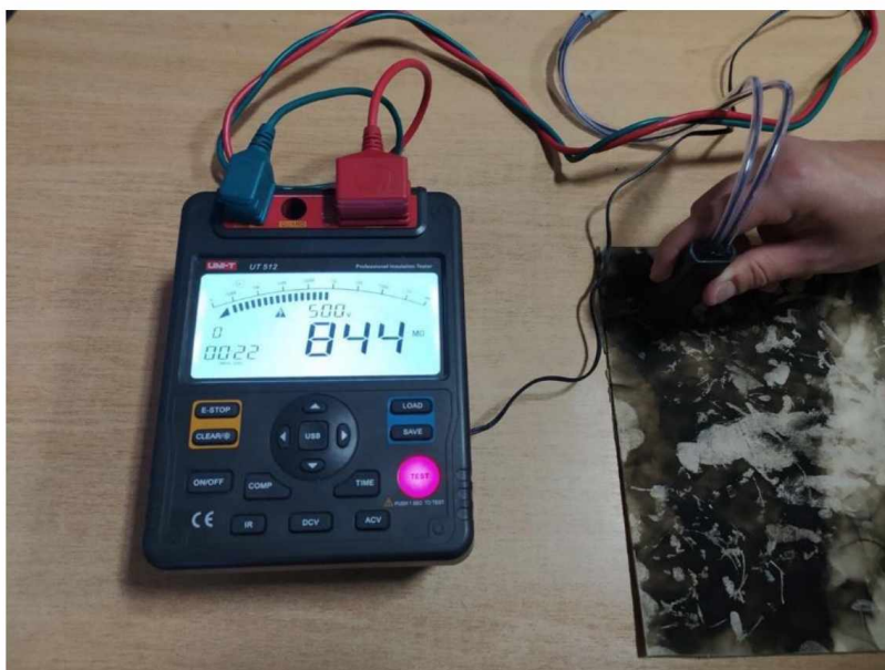
Рис. 5.11 Підключений датчик для вимірювання електричного опору шару кіптяви на горизонтальних поверхнях до приладу UNI-T 512
