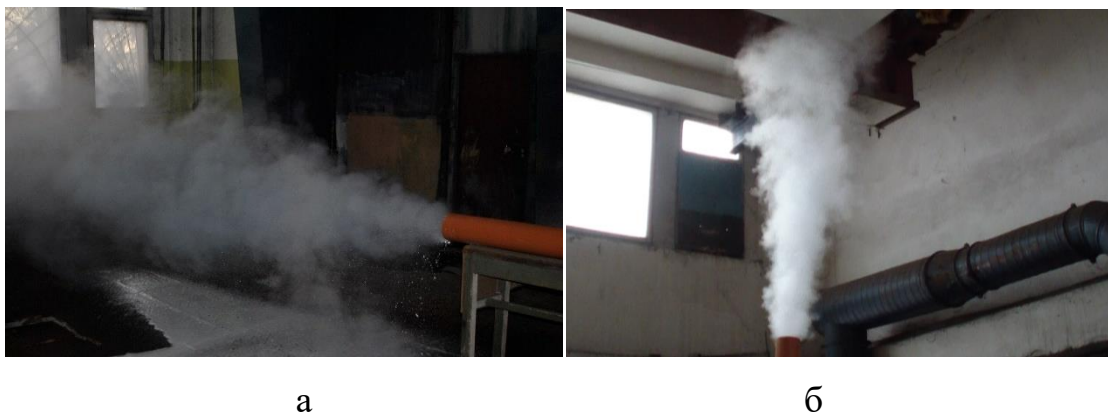
Рис. 5.8. Загальний вид подавання вогнегасної речовини із складної конструкції: а) труба ПВХ у горизонтальному положенні; б) труба ПВХ у вертикальному положенні
