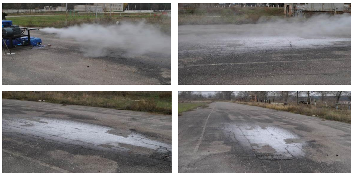
Рис. 5.4. Результати проведення експериментальних досліджень щодо осідання крапель води на земну поверхню
