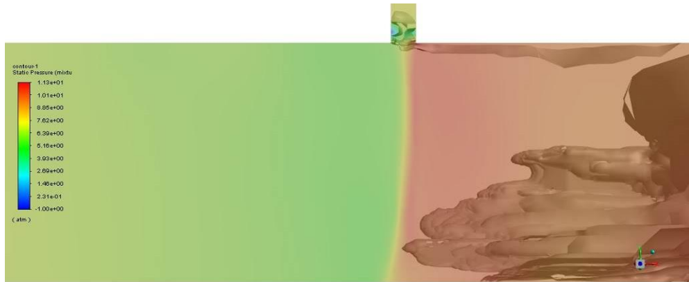
Рис. 2.15. Розподіл рідини у стволі на час 700 мкс від початку дії ударної хвилі
