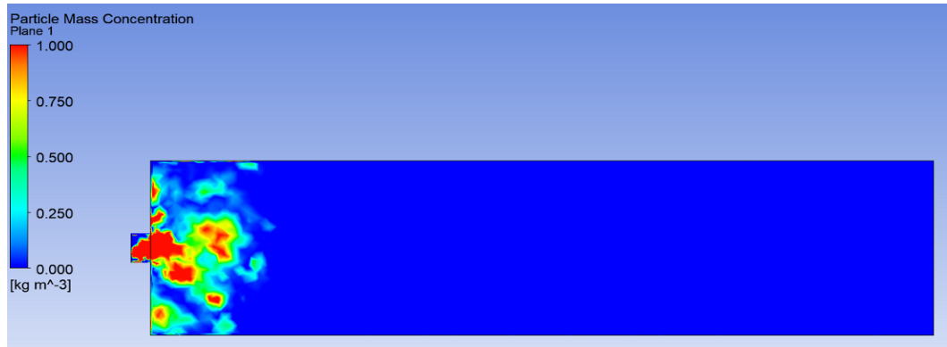
Рис. 2.28. Розподіл масової концентрації дрібнодисперсного водяного струменя у модельному приміщенні на час 35 с
