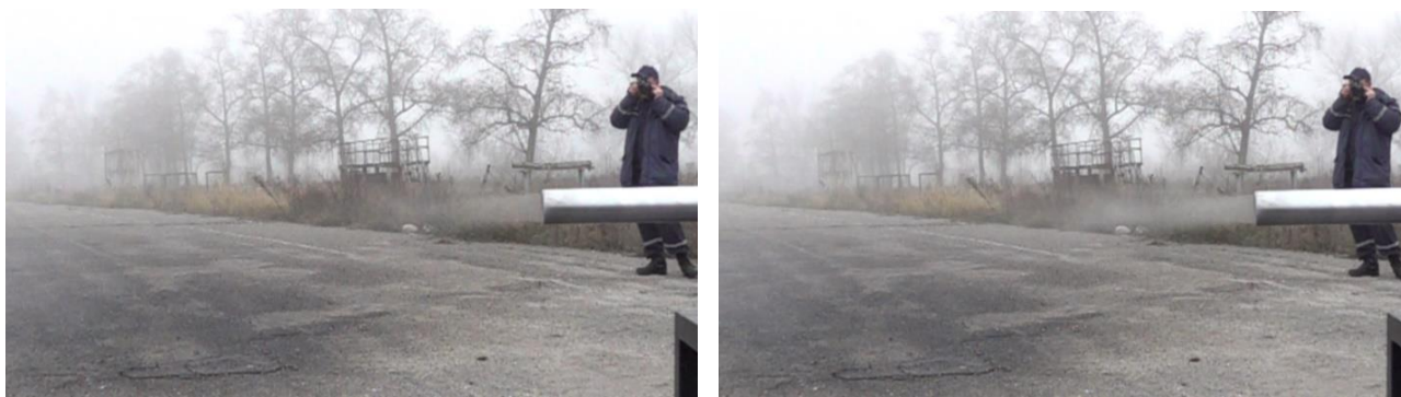
Рис. 5.1. Формування дрібнодисперсного водяного струменя за умови подачі води в ствол установки пожежогасіння періодично-імпульсної дії з продуктивністю 0,5 л/хв. Різниця у часі між кадрами ліворуч та праворуч дорівнює 1 мс
