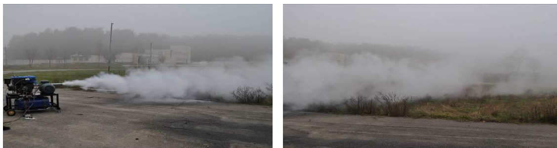
Рис. 5.3. Результати проведення експериментальних досліджень щодо визначення довжини та висоти розповсюдження дрібнодисперсного водяного струменя
