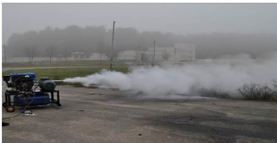
Рис. 5.12. Установка пожежогасіння періодично-імпульсної дії [121].
