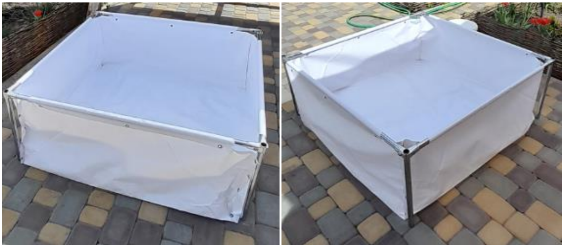
Рис. 5.17. Загальний вид розбірної проміжної ємності без води.
