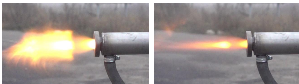
Рис. 4.15. Фотографії струменю продуктів детонації на виході зі ствола установки пожежогасіння періодично-імпульсної дії. Час між кадрами дорівнює 1 мс
