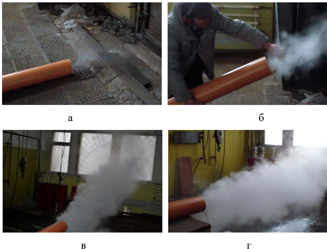
Рис. 5.7 Результати дослідження з визначення часу затримки виходу дрібнодисперсного водяного струменя при загальній довжині труб ПВХ 10 м: а) час 22 с; б) час 47 с; в) час 101 с; г) час 112 с [134, 135].
