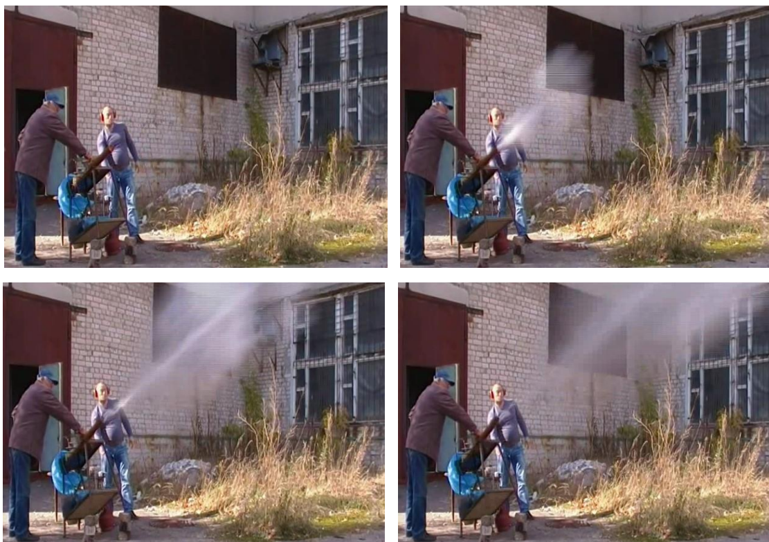
Рис. 3.7. Результати по-кадрового дослідження розпилювання води під час пострілу з дослідної установки імпульсного пожежогасіння за абсолютного початково тиску заряду 0,1 МПа
