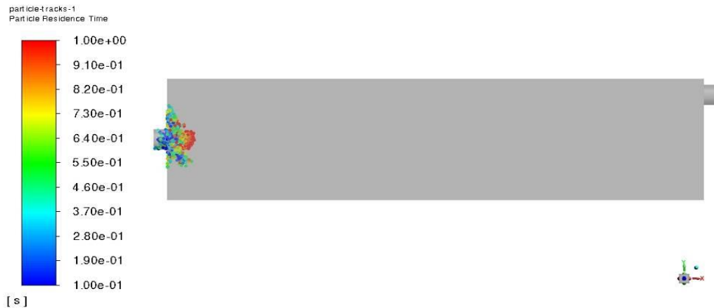
Рис. 2.20. Розподіл часток у модельному приміщенні за часом їх перебування у поперечному розрізі модельного приміщення на розрахунковий час 30 с
