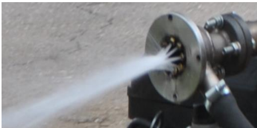
Рис. 4.6. Вигляд ствола установки пожежогасіння періодично-імпульсної дії без спрямляючого каналу під час роботи
