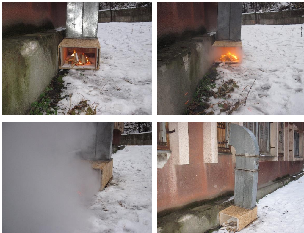
Рис. 5.11. Результати проведення експериментальних досліджень щодо гасіння осередку пожежі в приміщенні складної конфігурації
