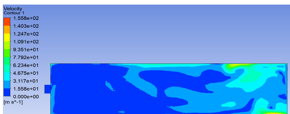
Рис. 2.36. Розподіл швидкості газового потоку у модельному приміщенні на час 140 с
