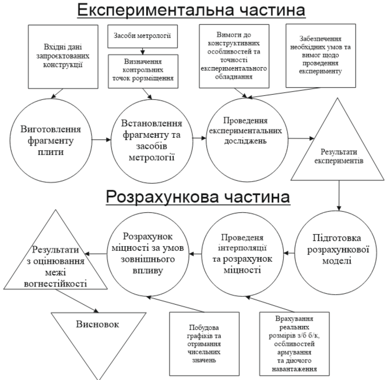
Рисунок 5.8. Детальна схема етапів проведення оцінювання межі вогнестійкості сталезалізобетонних плит з гофрованим профілем за удосконаленою експериментально-розрахунковою методикою
