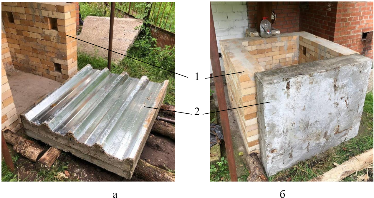
Рисунок 3.2. Фрагмент сталезалізобетонної плити з гофрованим профілем, виготовленої заздалегідь до випробування: 1 – огороження вогневої печі; 2 – фрагмент стале залізобетонної плити для випробування.
