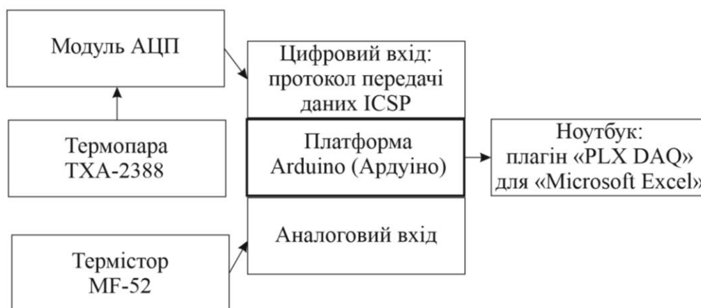
Рисунок 3.8. Принципова схема блоку комбінованого обчислення температур.
