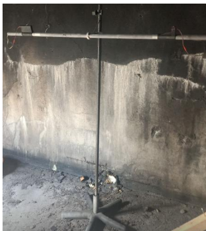
Рисунок 4.5 – Фото місця розташування лазерного випромінювача та приймача у споруді ВБ-40
