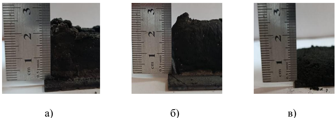
Рис. 4.7 Залежність лінійного коефіцієнта спучення сформованого спученого шару в залежності вмісту ПЕ 15 (а), 20 (б), 25 (в) мас.% у складі вогнезахисного покриття за фіксованого вмісту \text{Al}(\text{OH})_3 20 мас.%.
