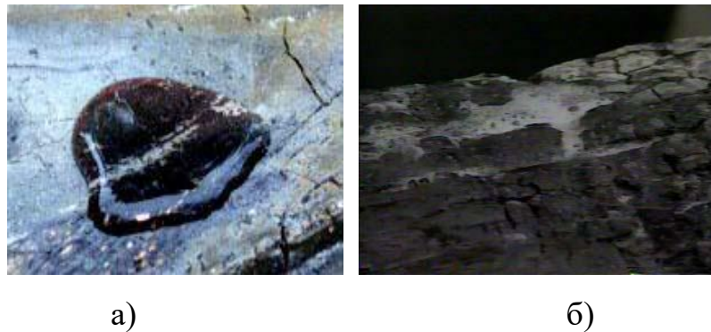
Рисунок 1.1. – Приклад зниження поверхневого натягу: а) вода; б) змочувальник
