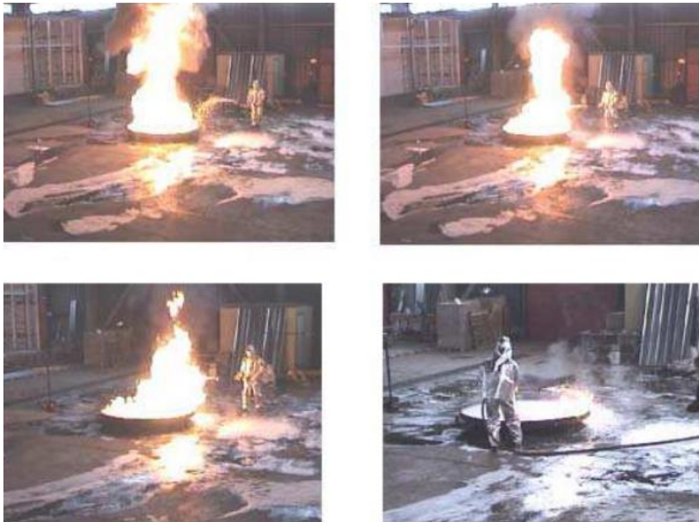
Рисунок 1.6 – Дослідження ефективності застосування компресійної піни під час гасіння модельного вогнища класу Б [65]
