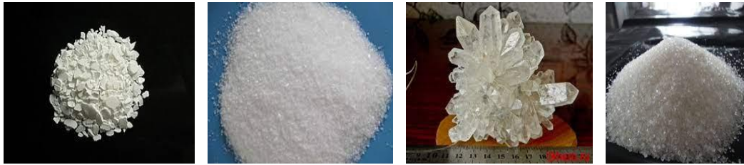
Рисунок 1.8 – Загальний вигляд першого типу модифікувальних добавок: а) \text{NH}_4\text{Cl} ; б) \text{NaCl} ; в) \text{KCl} ; г) \text{MgCl}_2 ; д) \text{CaCl}_2 ; ж) (\text{NH}_4)_2\text{HPO}_4 ; е) \text{NH}_4\text{H}_2\text{PO}_4 ; є) (\text{NH}_4)_2\text{SO}_4
