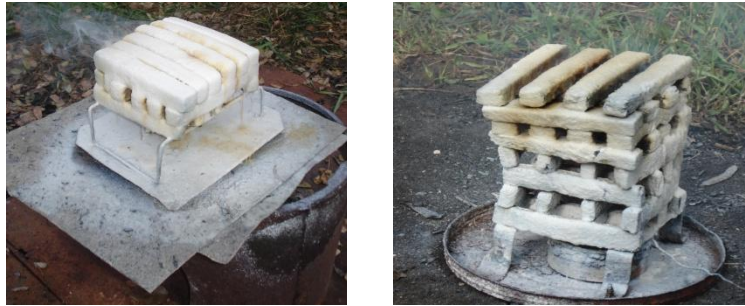
Рисунок 1.2 – Вогнезахисний шар ГУС [21]: а) модельне вогнище, погашене ГУС \text{CaCl}_2 + \text{Na}_2\text{O} \cdot 2,7 \text{SiO}_2 ; б) модельне вогнище, погашене ГУС \text{NH}_4\text{H}_2\text{PO}_4 + \text{Na}_2\text{O} \cdot 2,7 \text{SiO}_2 .
