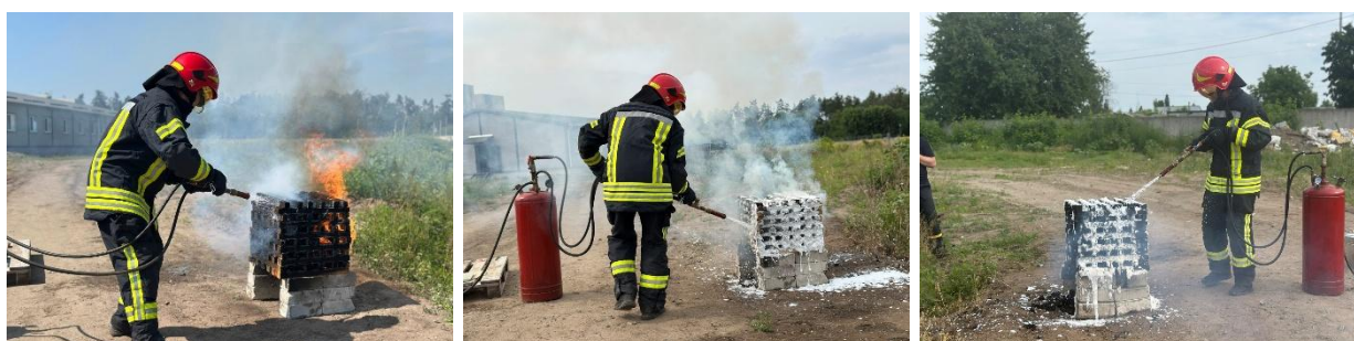
Рисунок 4.2 – Фото проведення експерименту: а) процес гасіння водою; б) процес гасіння компресійною піною традиційного складу; в) процес гасіння компресійною піною із \text{NH}_4\text{H}_2\text{PO}_4
