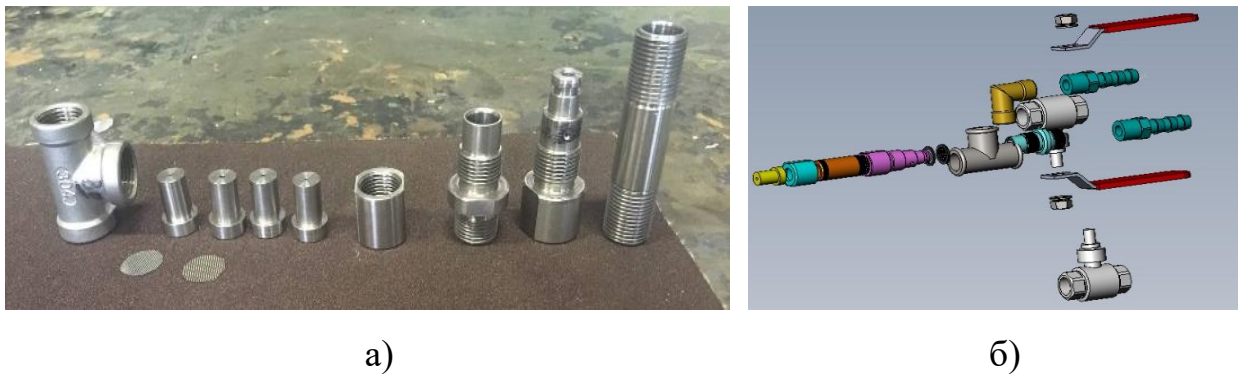
Рисунок 2.4 – Елементи розробленого ствола: а) фото виготовлених деталей; б) елементи у 3D-виді
