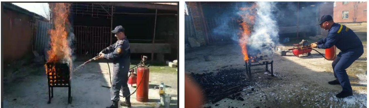
Рисунок 1.7 – Порівняння вогнегасної ефективності компресійної піни та води [80]
