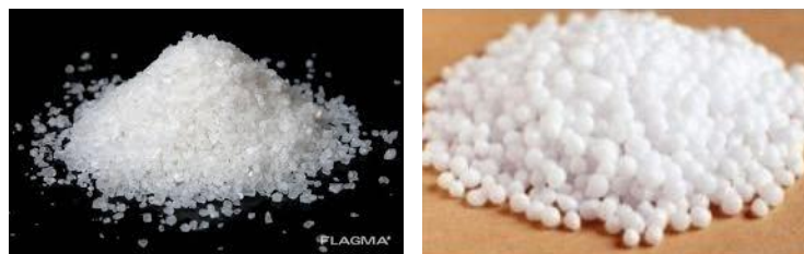
Рисунок 1.9 – Модифікувальні добавки другого типу: а) \text{NH}_4\text{Br} ; б) \text{CO}(\text{NH}_2)_2
