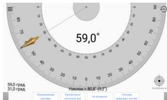
Рисунок 3.10. Інтерфейс мобільного телефону під час визначення кута схилу тіла звалищних ґрунтів на полігоні ТПВ.
