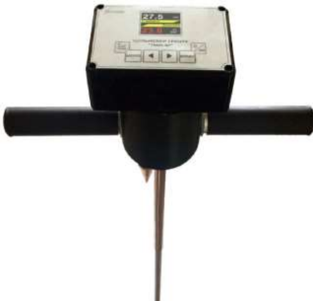
Рисунок 3.6. Щільномір ґрунту «ЛАН-М».
