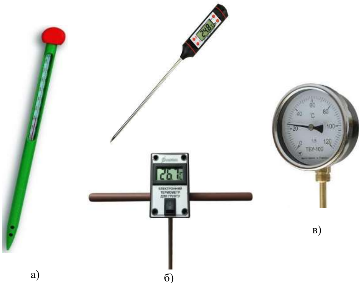
Рисунок 3.3. Термометр: а) ртутний для ґрунту, б) електронний, в) біметалевий радіальний.
