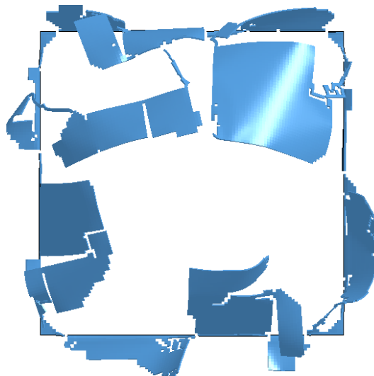
Рис. 2.18 - Зображення картин утворення тріщин у різні моменти часу перебігу пожежі.
