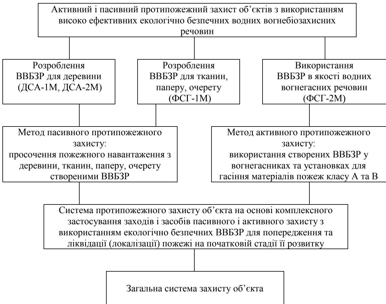
Рис. 14 - Схема реалізації системи СППЗО з використанням екологічно безпечних ВВБЗР
