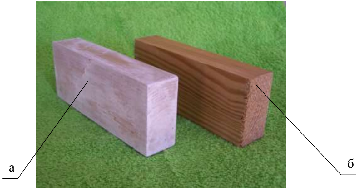
Рис. 6 - Зовнішній вигляд зразків деревини, оброблених ВВБЗР:
