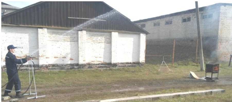
Рис. 7. Гасіння модельного вогнища 1А водою з використанням експериментальної установки АУГГУС-М
