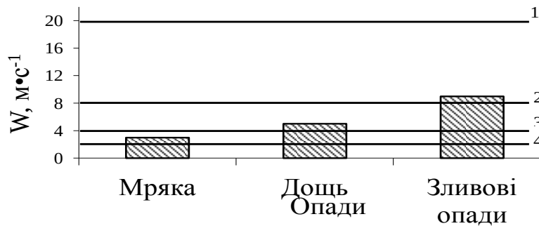
Рис. 13. Порівняльна діаграма швидкості витання крапель при різних опадах та швидкості вертикальних конвективних потоків (прямі): 1 – лісові верхові пожежі; 2 – лісові низові пожежі; 3 – степові пожежі; 4 – торф'яні пожежі
