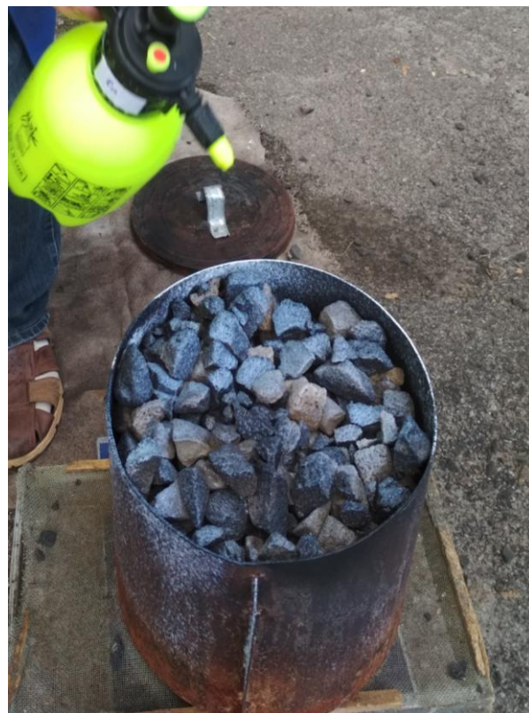
Рис. 4.11. Завершення гасіння шляхом подавання ГУС з витратою 0,2 г/см 2
