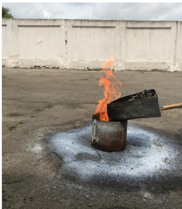
Рис. 4.15. Засипання змоченого ПС
