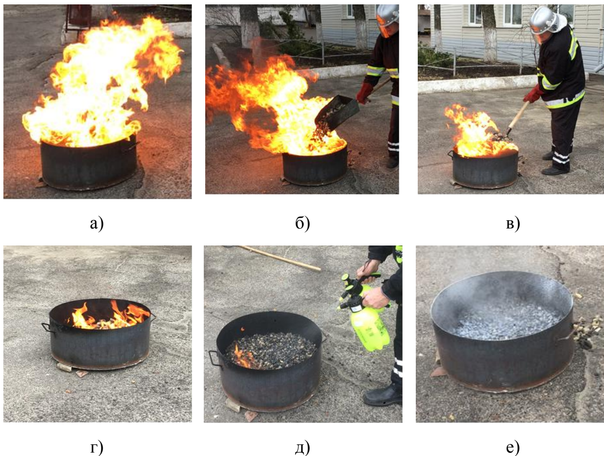
Рис. 4.24. Етапи гасіння модифікованого вогнища пожежі 8В: “а” – вільне горіння бензину, “б” – подавання ПС, в – зменшення інтенсивності горіння; “г” – слабе горіння; “д” – подавання ГУС, “е” – згасання вогнища
