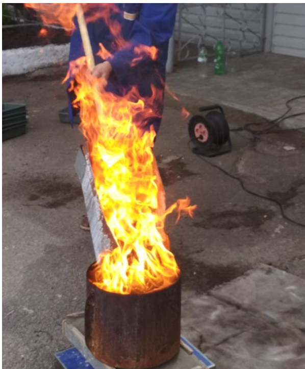
Рис. 4.18. Інтенсифікація горіння уайт-спіриту в початковий момент засипання змоченого ПС
