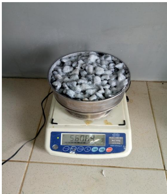
Рис. 3.12. Зважування ємності з бензином, ізольованою сіткою з бінарним шаром “ПС + гель”
