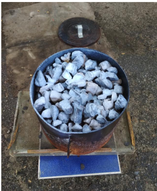
Рис. 4.12. Припинення горіння при подаванні ГУС з витратою 0,5 \text{ г/см}^2
