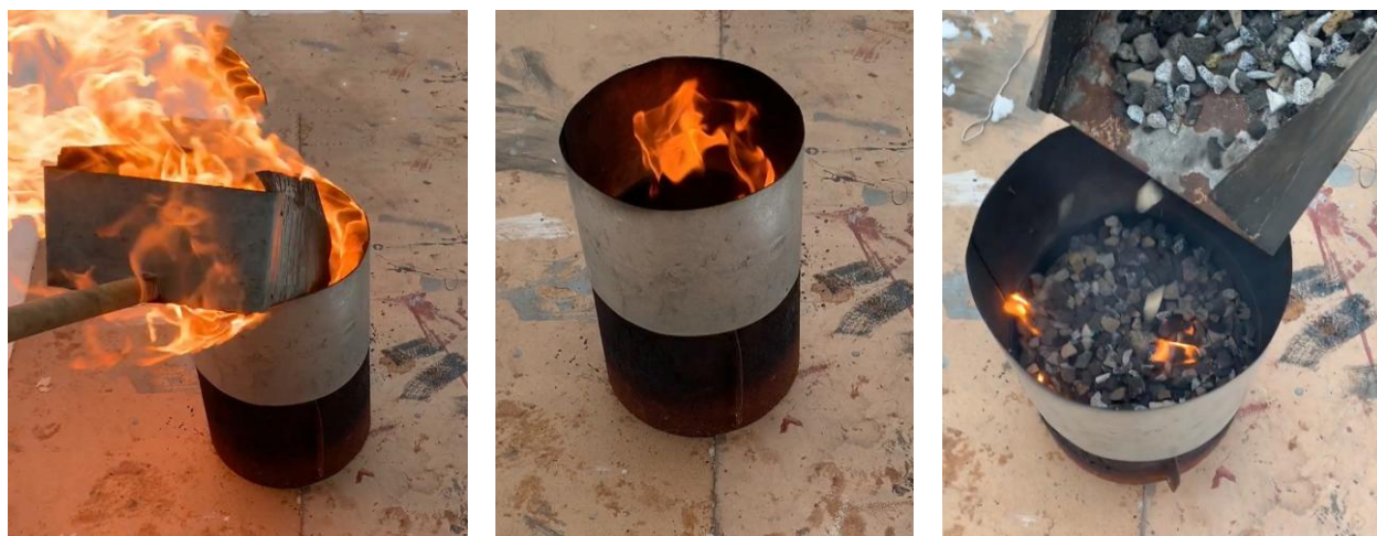
Рис. 4.22. Етапи гасіння модифікованого вогнища пожежі “2В”: а) – засипання ПС, б) – уповільнення горіння, в) – дуже слабе горіння
