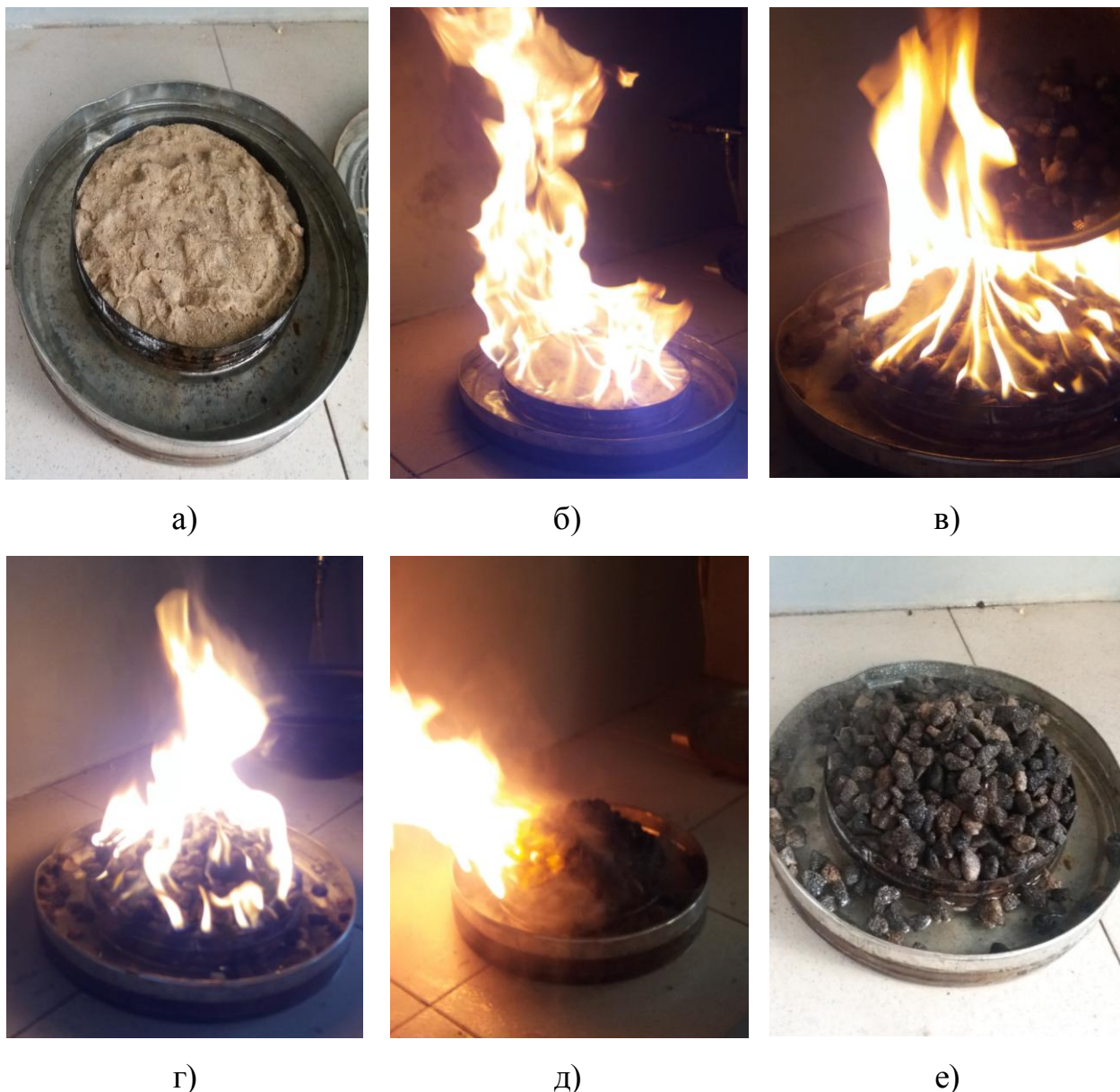
Рис. 4.25. Етапи гасіння просоченого бензином піску за допомогою ПС та ГУС: “а” – модельне вогнище пожежі; “б” – вільне горіння піску з бензином; в – засипання ПС; “г” – горіння з шаром ПС 5 см; “д” – подавання ГУС; “е” – припинення горіння
