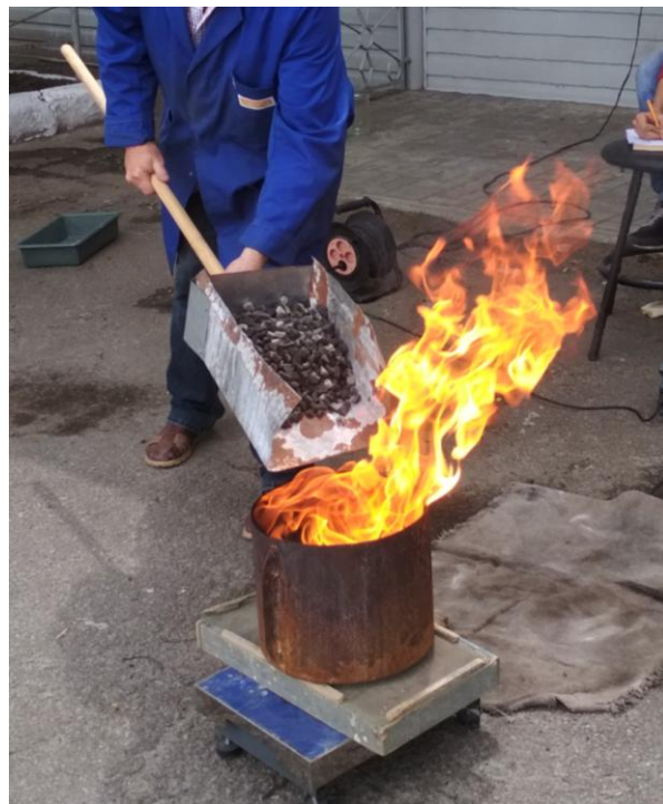
Рис. 4.19. Послаблення горіння під час засипання другої порції змоченого ПС
