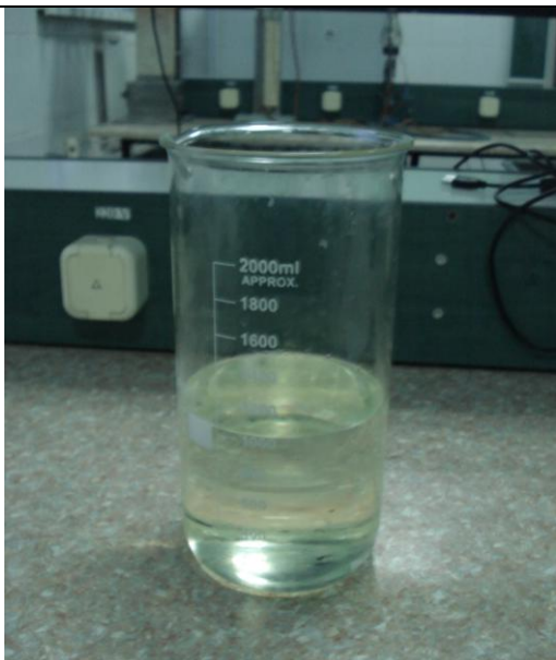
Рис. 2.4 Стакан із залитою горючою рідиною
