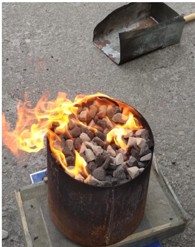
Рис. 4.10. Інтенсивність горіння бензину при максимальному шарі ПС на стандартному вогнищі 2В
