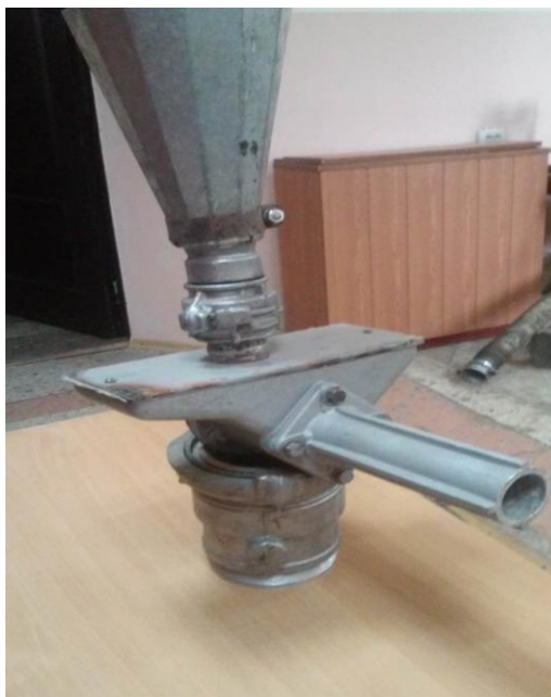
Рис. 2.6 Ежекційний апарат для подачі гранульованого ПС
