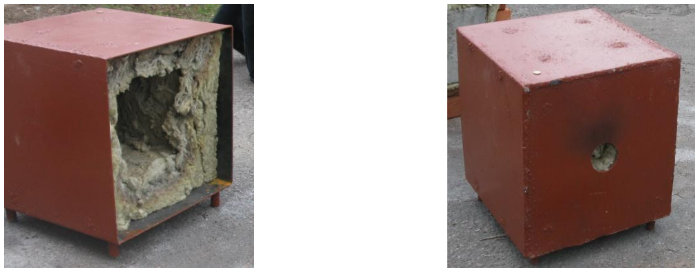
Рис. 2.1. Камера установки для проведення вогневих випробувань деревини
