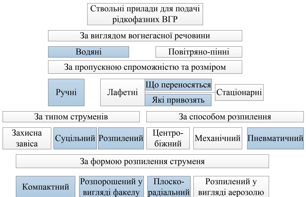
Рис. 1.2 Загальна класифікація використання пожежних стволів та насадків
