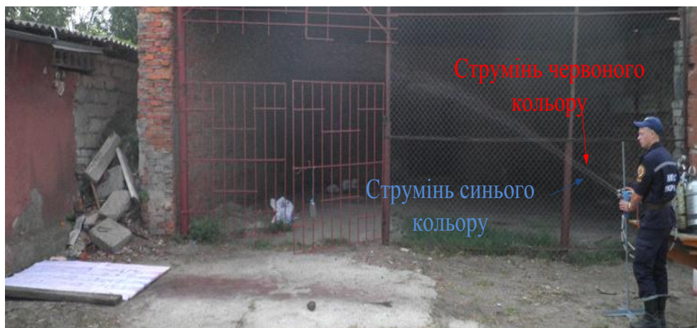
Рис. 2.15 Приклад подачі ВГР з передчасним змішуванням компонент ГУС,
