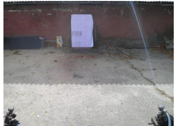
Рис. 2.10 Умови проведення експериментів: а) розміщення стволів-розпилювачів C_1 і C_2 , що подають на умовний осередок пожежі (точка E ) компоненти бінарного потоку ГУС: \alpha_1 і \alpha_2 – кути нахилу до горизонту стволів, \psi_1 і \psi_2 – кути їх відхилення, 2a – відстань між стволами на рівні h_1 = h_2 = h ; б) фото «прицільної подачі» 1-м стволом одного струменя складової ГУС, в) фото «прицільної подачі» 2-м стволом іншого струменя складової ГУС
