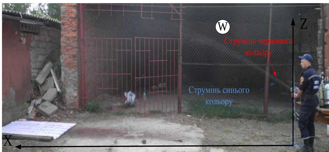
Рис. 3.5 Фото випробувань експериментальних установок типу АУГГУС (проекція на площину W ), з імітацією подачі потоку компонент ГУС зі стволів-розпилювачів, розташованих дуплетом (паралельно один над іншим) з однаковими кутами нахилу до горизонту \alpha = 30^0 та з нульовим кутом відхилення \psi = 0 (максимальна дальність L_{\max} = 5 м)
