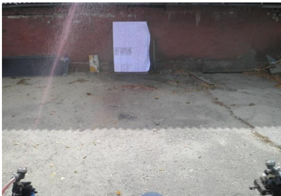
Рис. 2.10 Умови проведення експериментів: а) розміщення стволів-розпилювачів C_1 і C_2 , що подають на умовний осередок пожежі (точка E ) компоненти бінарного потоку ГУС: \alpha_1 і \alpha_2 – кути нахилу до горизонту стволів, \psi_1 і \psi_2 – кути їх відхилення, 2a – відстань між стволами на рівні h_1 = h_2 = h ; б) фото «прицільної подачі» 1-м стволом одного струменя складової ГУС, в) фото «прицільної подачі» 2-м стволом іншого струменя складової ГУС
