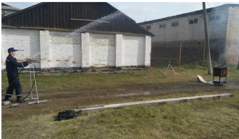
Рис. 3.8 Гасіння модельного вогнища 1А водою з використанням експериментальної установки АУГГУС-М
