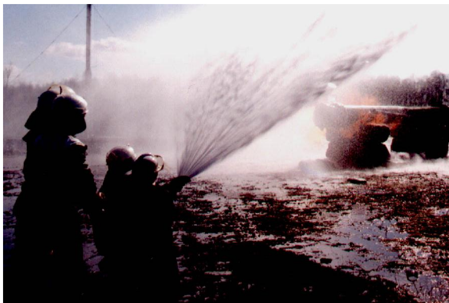
Рис. 2.5 Подача ВГР у вигляді плоско-радіальних струменів водних розчинів, відповідно до патенту України [2, 4]
