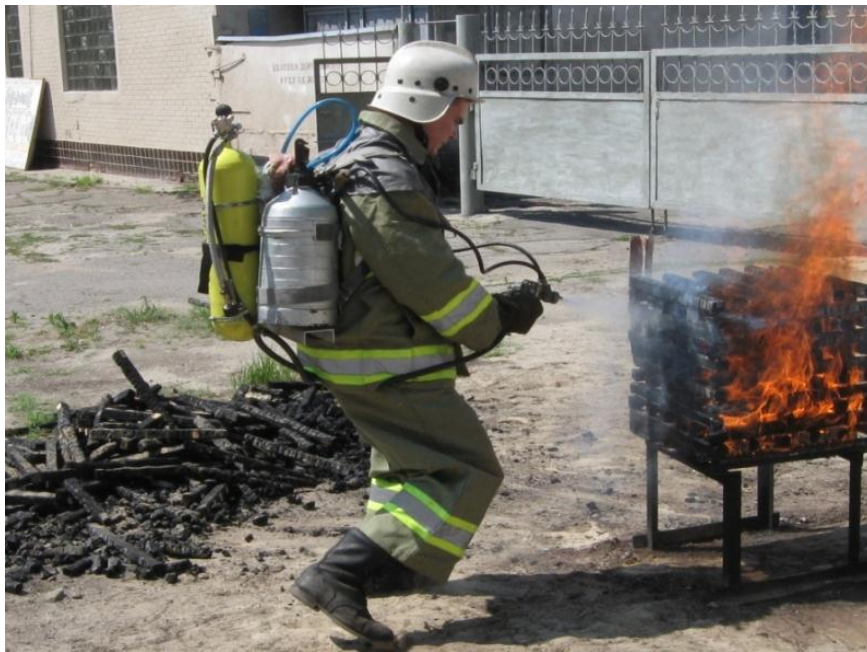
Рис. 2.12 Гасіння гелеутворюючими складами, модельного вогнища 1А, установкою АУГГУС-П
