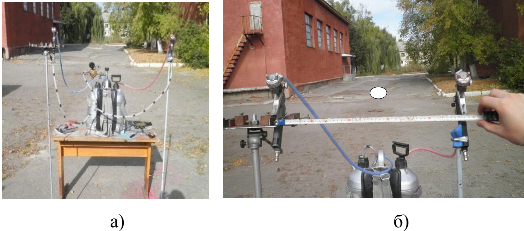
Рис. 2.9 Фіксація стволів-розпилювачів при проведенні експериментів:
