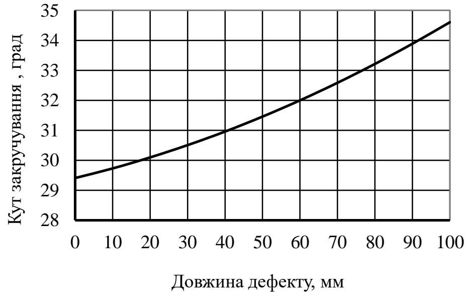
Рис. 3.26. Експериментальна залежність (рівняння 3.13) кута закручування рукава \varnothing 77 мм від довжини дефекту по основи
