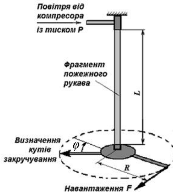
Рис. 3.12. Схема дослідної установки
