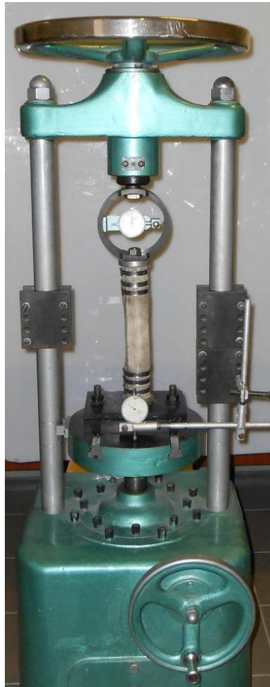
Рис. 3.5. Дослідна машина ДМ-30М із встановленим зразком рукава
