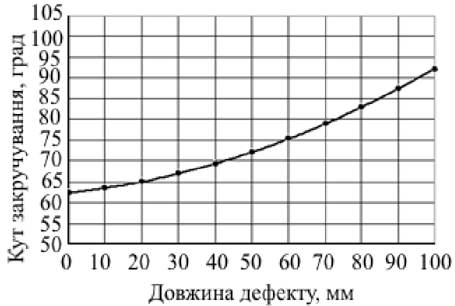
Рис. 2.13. Розрахункова залежність кута закручування рукава \varnothing 51 мм від довжини дефекту по основі
