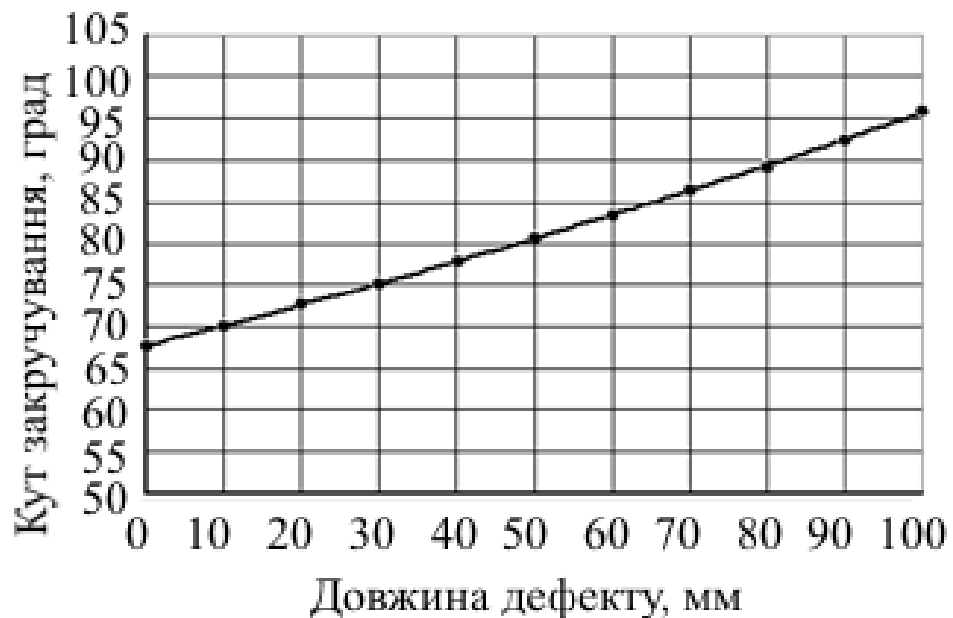
Рис. 2.14. Розрахункова залежність кута закручування рукава \varnothing 51 мм від довжини дефекту по утку
