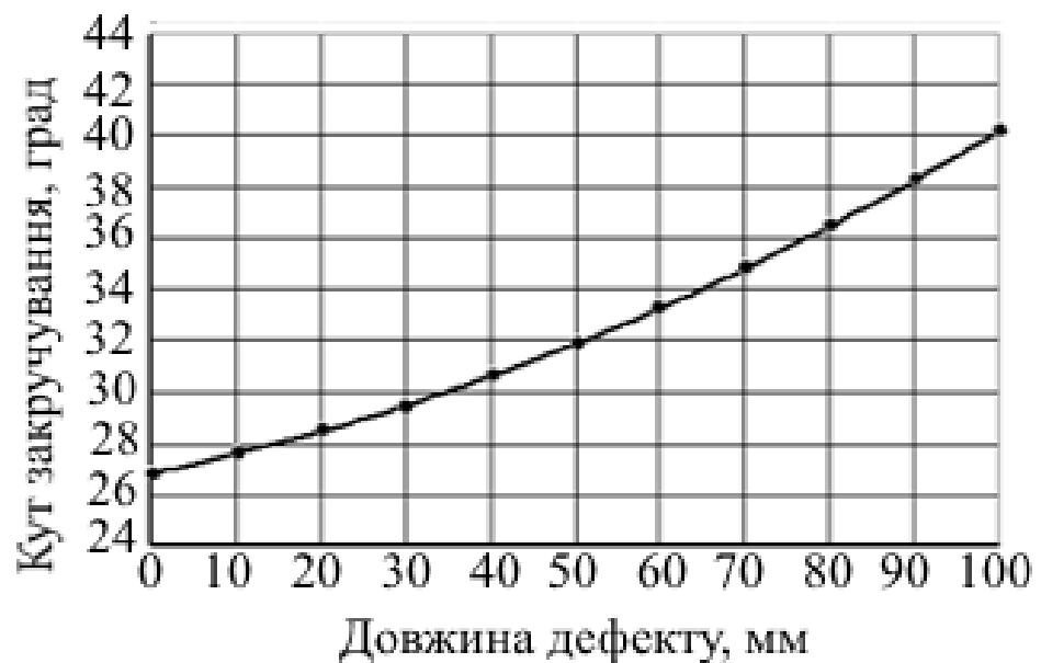
Рис. 2.16. Розрахункова залежність кута закручування рукава \varnothing 77 мм від довжини дефекту по утку
