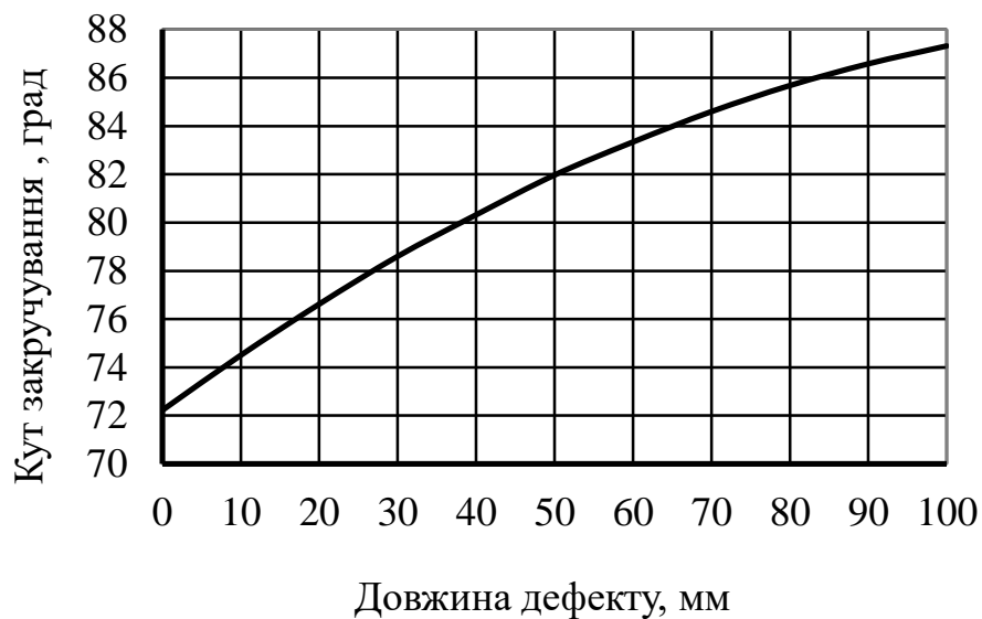
Рис. 3.23. Експериментальна залежність (рівняння 3.8) кута закручування рукава \varnothing 51 мм від довжини дефекту по утку
