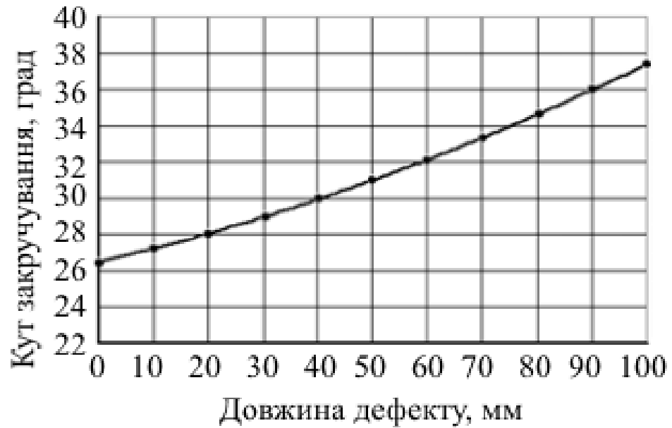
Рис. 2.15. Розрахункова залежність кута закручування рукава \varnothing 77 мм від довжини дефекту по основі
