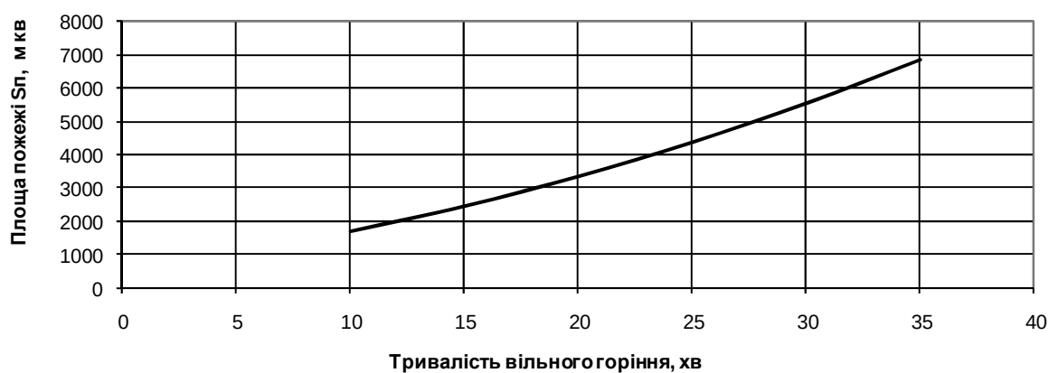
Рис. 4.2. Вплив тривалості вільного горіння \tau_{в.г} на площу пожежі S_{\Pi}
