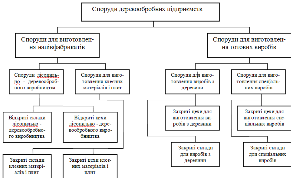
Рис. 2.1. Схема класифікації споруд деревообробних підприємств
