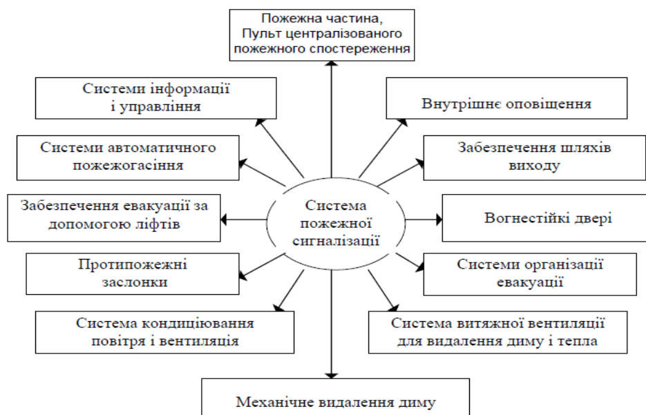
Рис. 1.7. Система пожежної сигналізації (СПС) для протипожежного захисту об'єкта [237]
