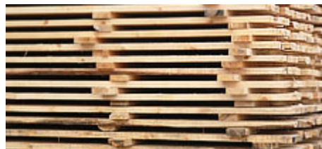
Рис. 6.7. Фрагменти поверхонь штабелів пиломатеріалів: а – з утворенням зазорів між шарами; б – без утворення зазорів (торцева поверхня штабеля)
