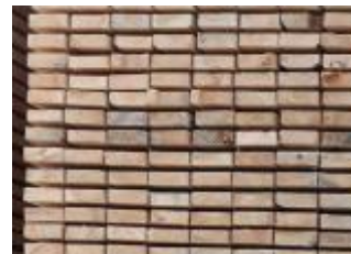
Рис. 6.7. Фрагменти поверхонь штабелів пиломатеріалів: а – з утворенням зазорів між шарами; б – без утворення зазорів (торцева поверхня штабеля)
