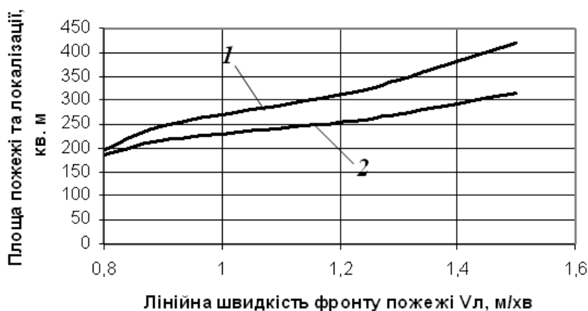
Рис. 4.11. Вплив лінійної швидкості розповсюдження фронту пожежі V_{\text{л}} на: 1 – площу пожежі; 2 – площу локалізації
