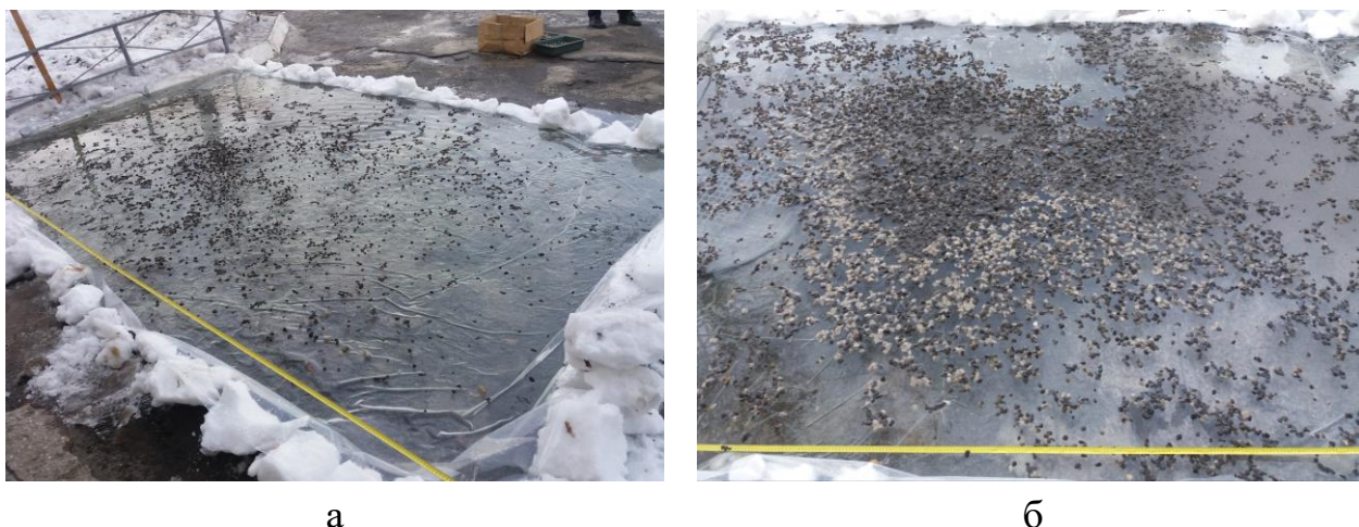
Рис. 17. Етапи проведення експерименту за розподілом ПС поверхнею рідини: а – початок подачі; б – поступове заповнення поверхні рідини
