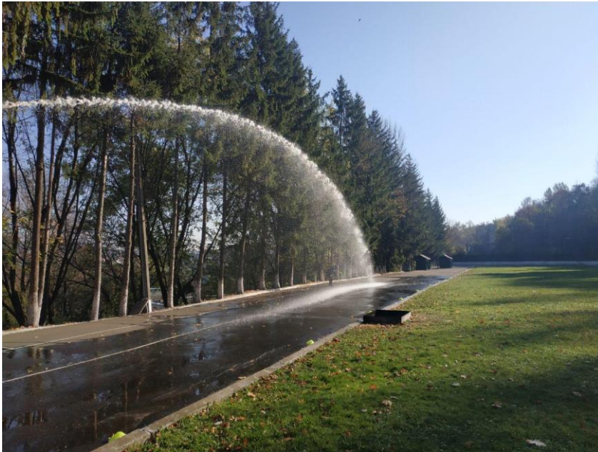
Рисунок 1. – Траєкторія польоту суцільного струменя лафетного ствола
