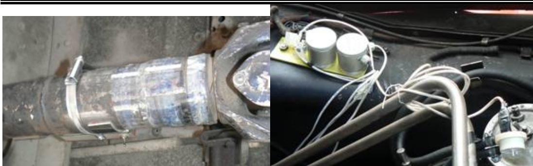
Рисунок 2 – Розміщення тензометричного моста, передавального пристрою на карданному валі (а) і витратоміра в моторному відсіку автомобіля (б)
