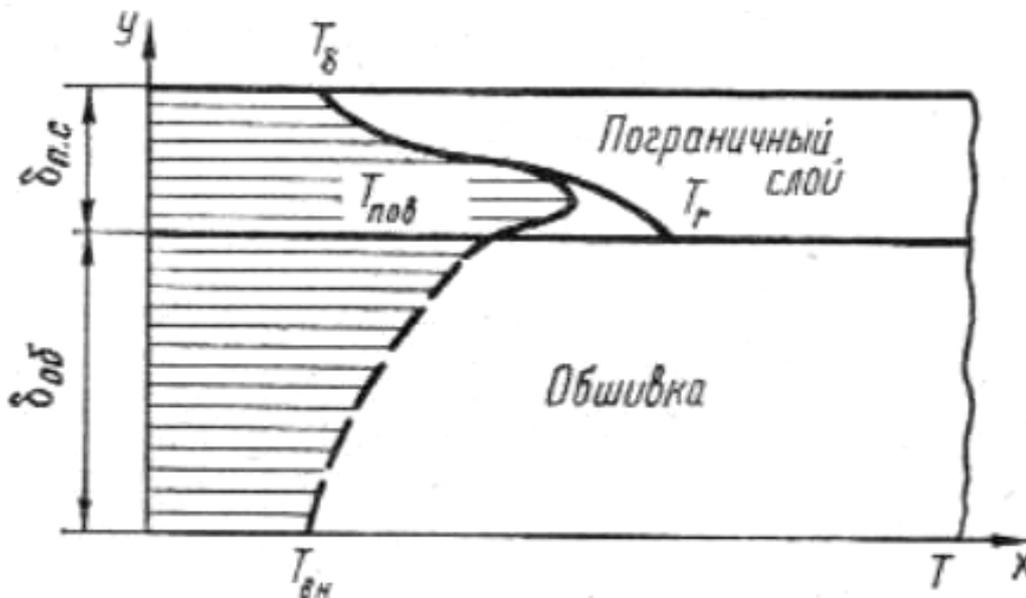
Рис. 1. – Распределение температуры по толщине пограничного слоя и обшивки самолёта
