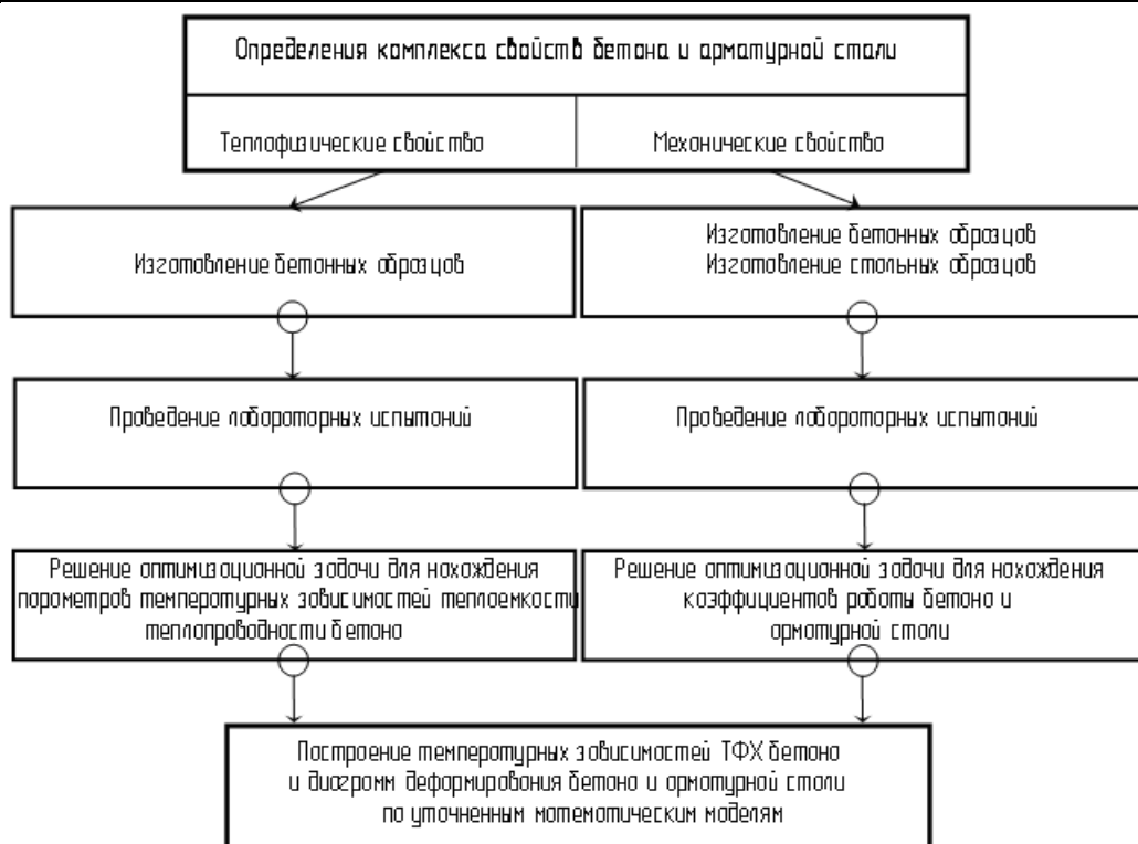
Рис. 2 – Структурная схема получения комплекса свойств бетона и арматурной стали в условиях нагрева экспериментально-расчетным методом
