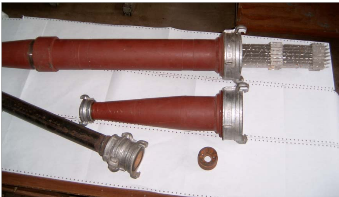
Рис. 3 – Общий вид проточной кассеты для приготовления полимерных растворов из ТВПК (ультраслабых полимерных покрытий) и флоковых покрытий с растворимыми полимерными наполнителями на армирующих вставках
