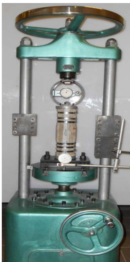
Рис. 1. Дослідна машина ДМ-30М із встановленим зразком рукава
