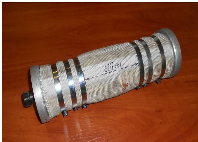
Рис. 4 – Випробувальний зразок пожежного рукава діаметром 77 мм
