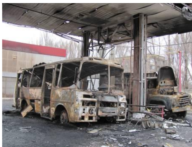
Рис. 1. Пошкодження в результаті вибуху метано-повітряної суміші автотранспортних засобів та будівельних конструкцій на багатопаливному автозаправному комплексі
