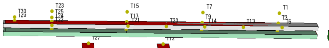
Рис. 4. Схема розташування місць контролю температури у кабельному тунелі: T1 – T30 –місця контролю
