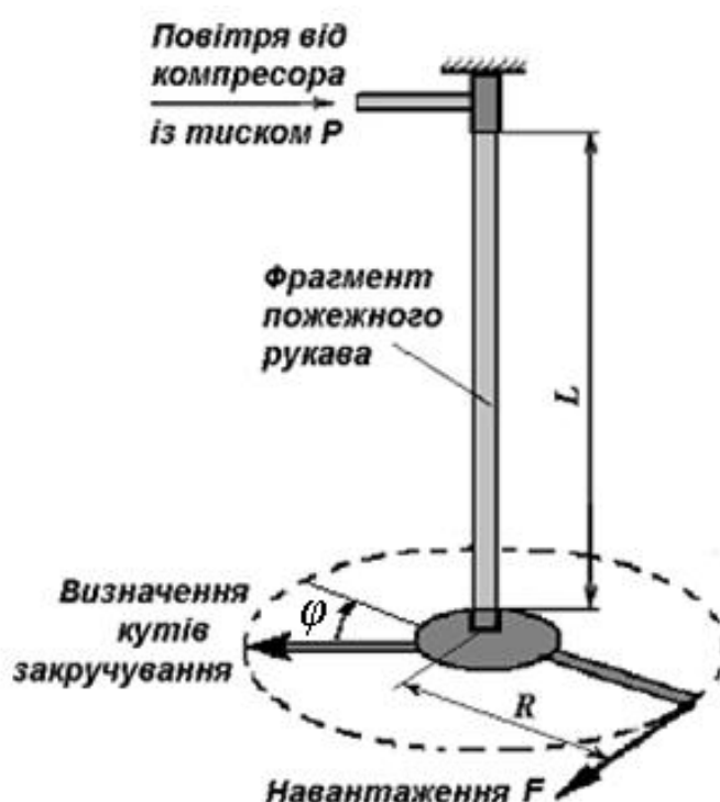
Рис. 1. Дослідна установка із встановленим фрагментом пожежного рукава
